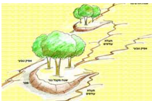
מערכת של שני לימני אפיק, הראשון תורם מים לשני
