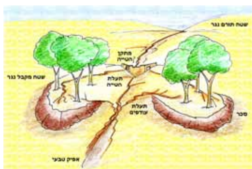
שני לימני צד ממוקמים לצדי אפיק מתחת למתקן הטיית מים
