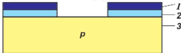
Рис 104. Кремниевая пластина с “окном” в слое SiO 2 , образовавшимся в результате облучения и последующего травления: 1 - фоторезист, 2 - слой SiO 2 , 3 - полупроводниковая пластина;
