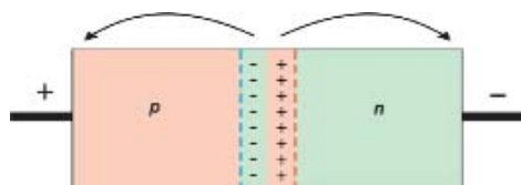
Рис 94. Прямое включение р-n перехода
