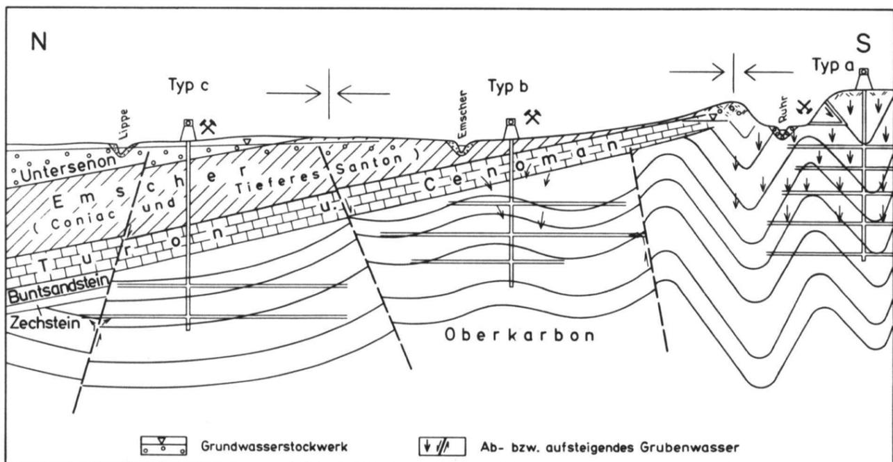
Abb.4 : Grubenwasserzonen im Ruhrrevier; schematischer Schnitt nach
