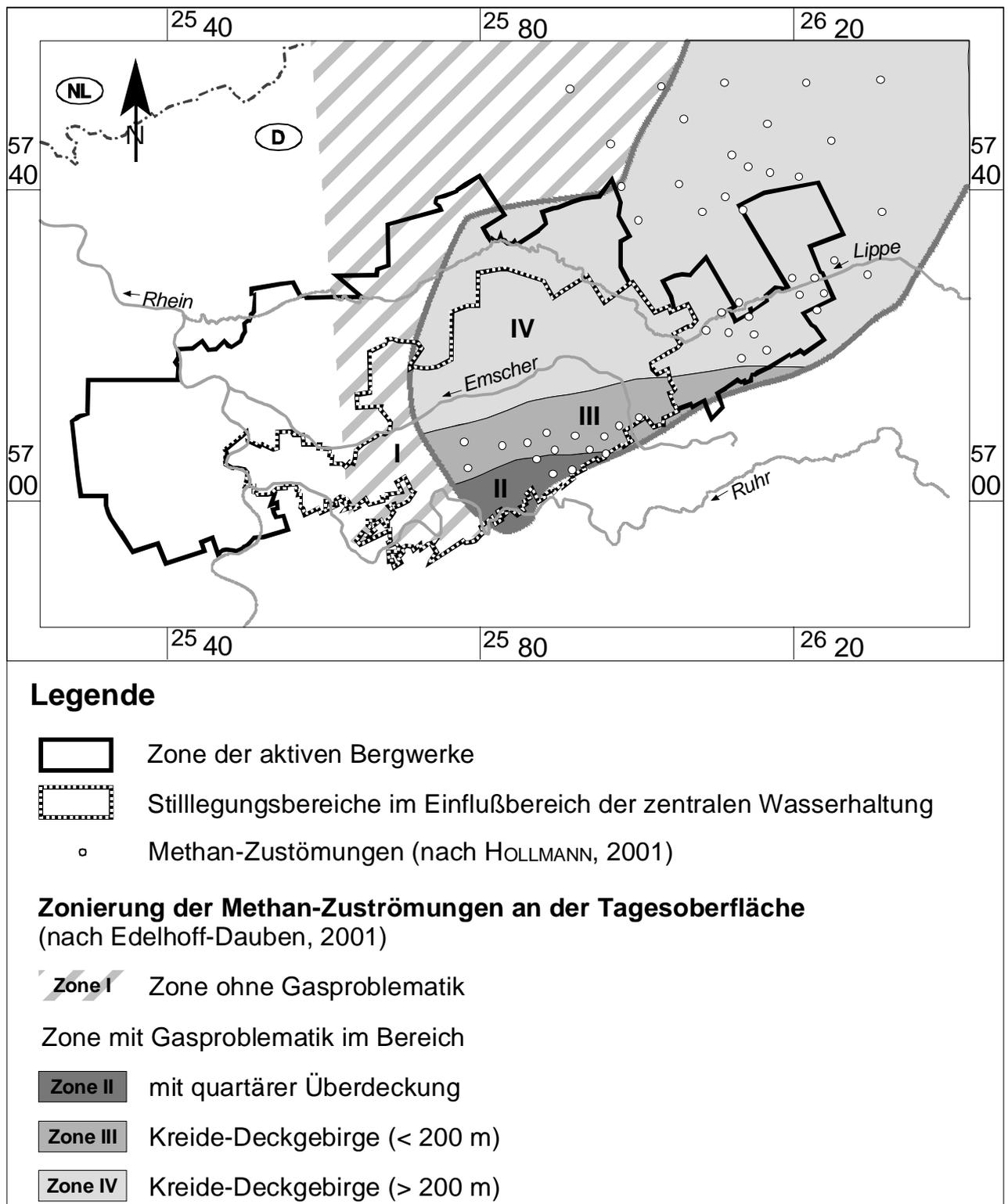
Abb.5 : Zonierung von Methan-Ausströmungen an der Tagesoberfläche
