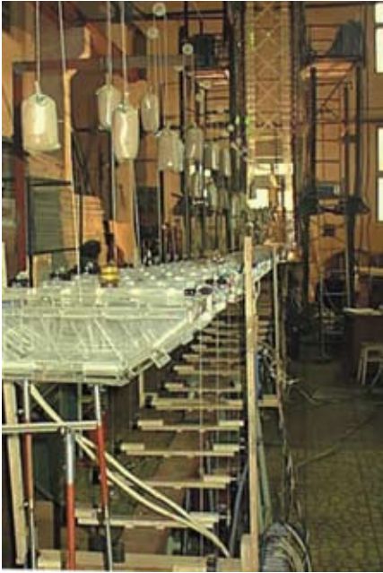
Рис. 5. Физическая модель моста в масштабе 1:30
