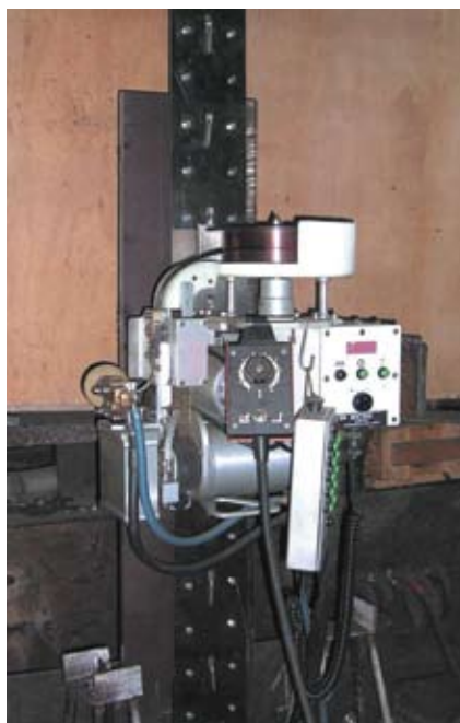
Рис. 3. Сварочный аппарат вертикальной автоматической сварки «Восход»
