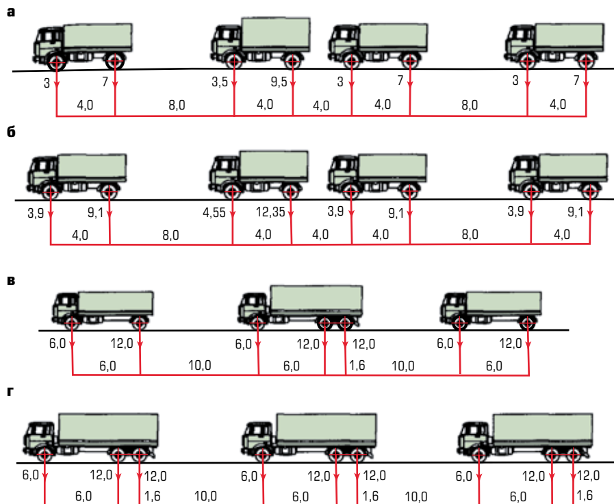
Рис. 2. Эволюция схем временных нагрузок для автодорожных мостов: а — нормы 1931 года; б — нормы 1938 года; в — нормы 1953 г.; г — нормы 1962 года.
