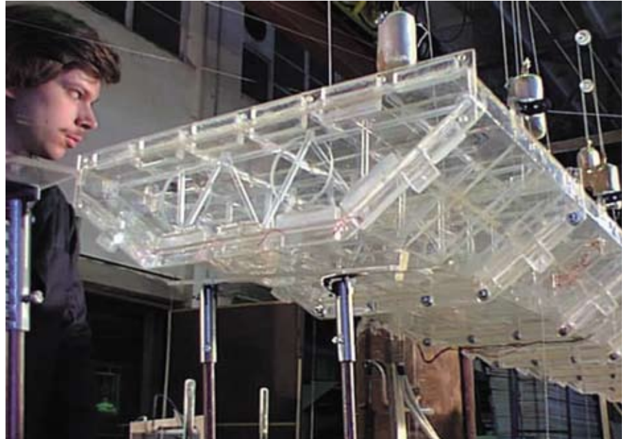
Рис. 6. Процесс монтажа блока балки жесткости физической модели
