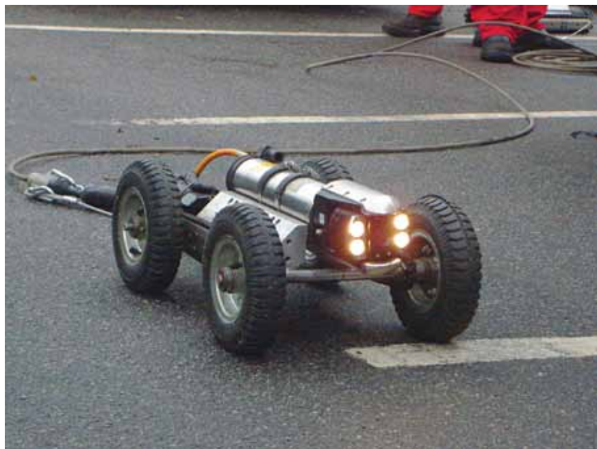
O mini-robô tem câmera de alta definição e se desloca facilmente nas redes de águas pluviais
