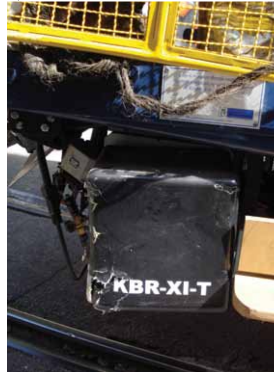
Caixa de freio do bondinho avariada pela colisão
