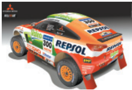
ボディのフォルムは『ランサー スポーツバック』そのまま、絞り込まれたリヤゲートの奥には3本のスベアタイヤがしっかりと収まっている
