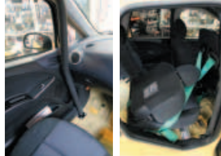
ここには競技車両の製作例の写真を掲載した。ロールオーバーのバンプ径は40mm。セーフティバーネスのアンカーはリヤシートの後部のフロア部に取った。また、ロールオーバーはダッシュボード貫通式ではないため、エアコンの吹出口も生かす。ただし、グローブボックスの開閉を行うためにフタをカットするなどの工夫をしている
