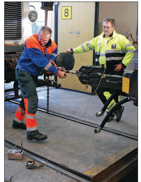
Joakim Jörgensen og Arne Tangen tester parkeringsbrems på BMX. Hjelpekobbel påsatt togsett 14 til høyre i bildet. Foto: Espen Hagen.
