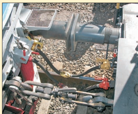
Hovedledning og apparatledning. (Foto: Jan Haugen)
