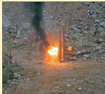
Bilde viser en acetylenflaske som er beskyttet for kontrollert av brenning.
