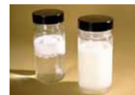
links: Unbehandeltes UHMW PE rechts: INHANCE® UHMW PE
