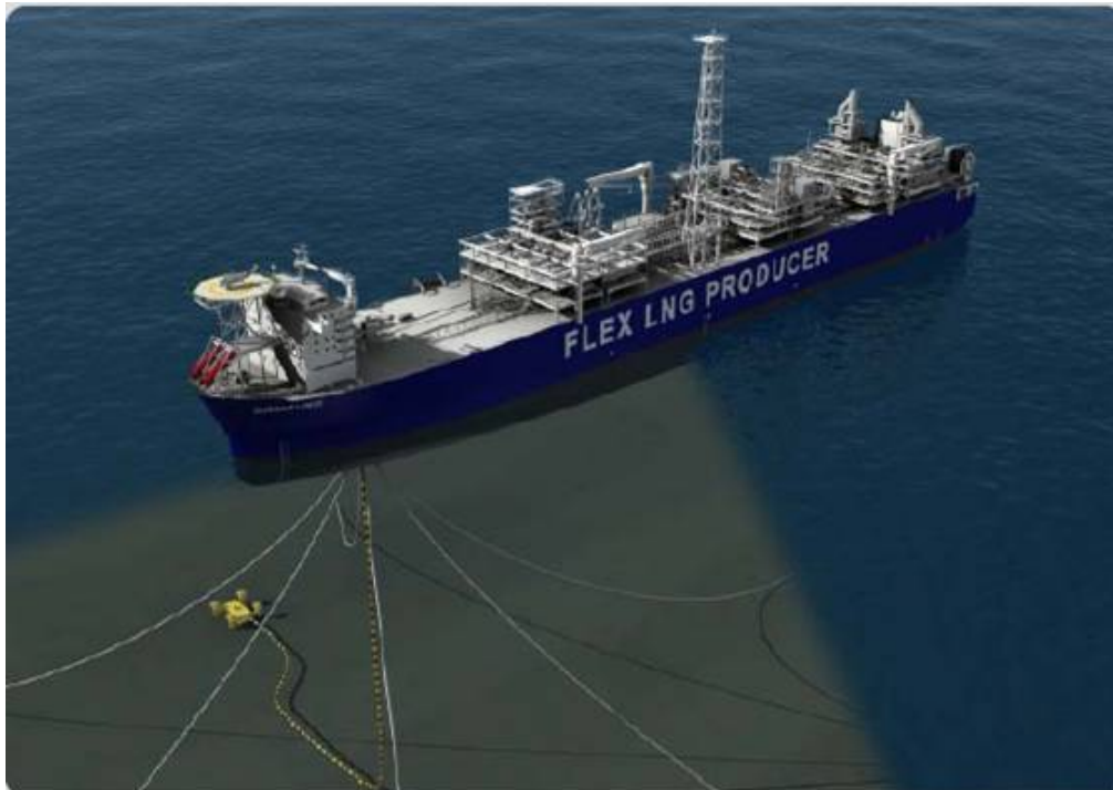
Figure 3-1: Turret-moored LNG FPSO – Courtesy FLEX LNG & Samsung
