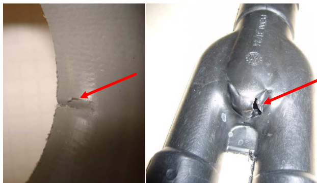
Abb. 13: Risse in Biegungen oder Formteilen der PE-Sonden nach Druckbeaufschlagung /4/
