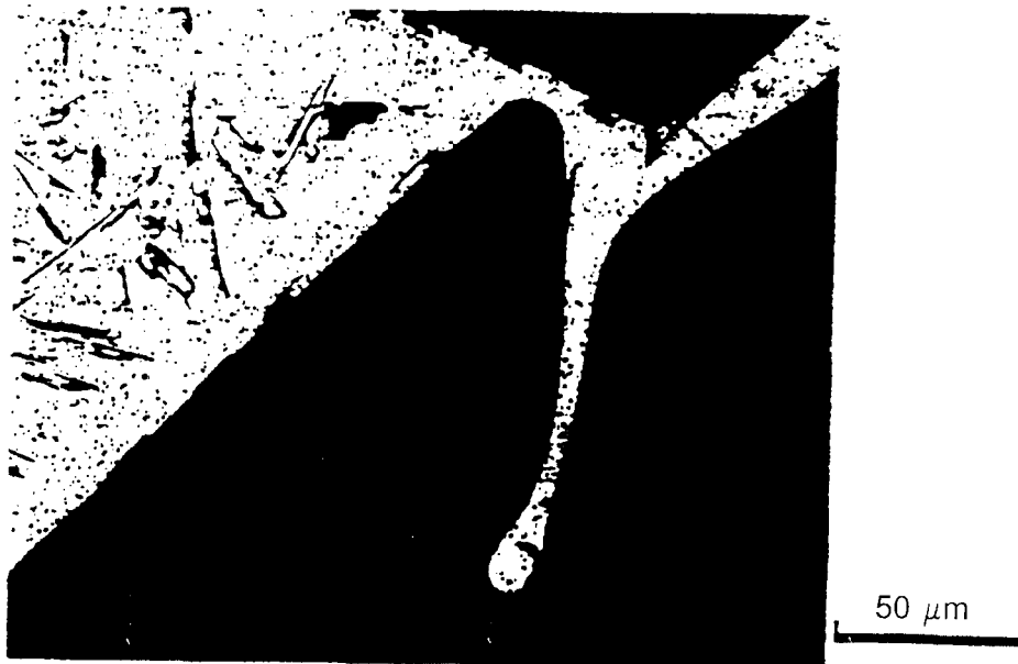
Figura 2. Microestructura de la colada en palanquilla de la aleación de Al-70 % en peso de Si con mucho aumento.
