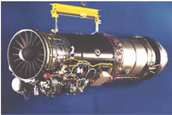
F 404-Ge-402: 5380 kg Schub ohne Nachbrenner, 8028 kg Schub mit Nachbrenner („Hornet“ F/A- 18 C/D); Zweiwellen- Zweistromtriebwerk.
