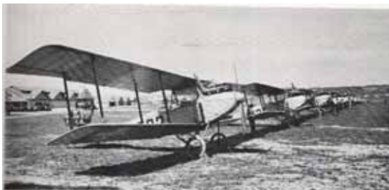
1917: DH-3 K+W, Thun mit Argus II-Motor. 24 Flugzeuge. Auch dieses Flugzeug befriedigte nur zum Teil.
