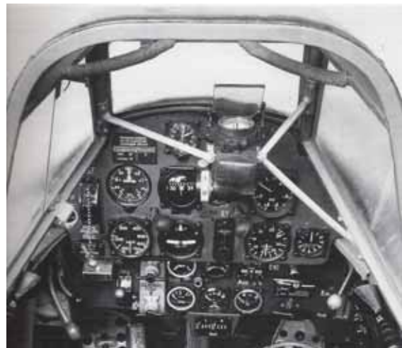
Das „Revi“, wie es im Flz Me-109E eingebaut war. Weil es im Original einbau beim Schiessen leicht vibrierte, wurde es bei uns verstrebt
