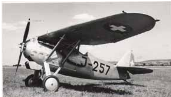
Devoitine D-27. Metallstringer und Alu-Schale, künftig Standard für alle Flugzeuge mit Ausnahmen
