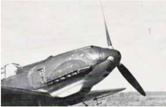
Me -109E: wurde mit VDM- Verstellpropellern geliefert. Der VDM-Propeller wurde elektrisch betätigt. Wegen der häufigen Störungen wurden sie später durch Escher- Wyss Propeller ersetzt
