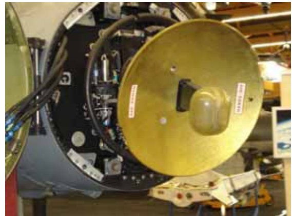
Das Bordradarsystem „Taran“ des Flz „Mirage IIIS“
