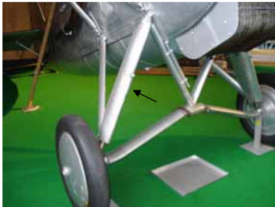
D-27. Festes Fahrwerk mit integriertem Stossdämpfer Mésurier
