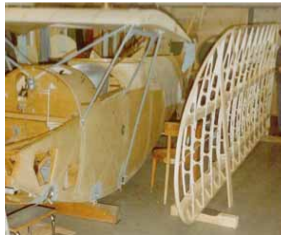
DH-5 :Holzschalenrumpf und Holzflügel
