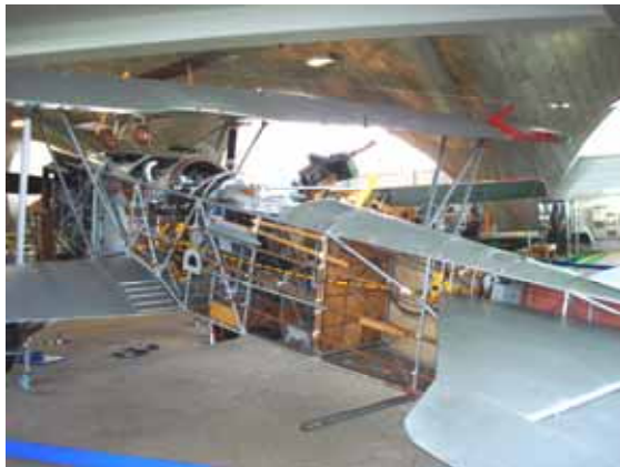
Fokker CV, drahtverspannter Stahlrohrumpf mit Stoff überzogen
