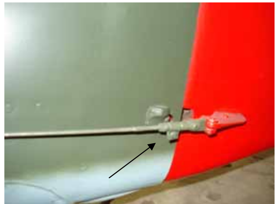
Eine Presshülse am Ende der Seile
