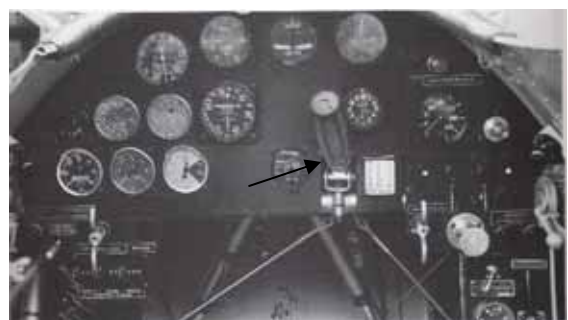
CV und C-35: Betätigung der Bremse mittelst einem Hebel im Pilotenraum über ein Drahtseil.
