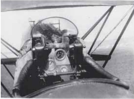
Synchronisiertes Maschinengewehr über dem Motor, durch den Propellerkreis schießend.
