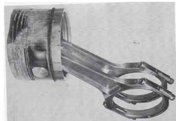
Kolben, welcher wegen des Klopfens infolge zu niedriger Oktanzahl „anfrass“.
