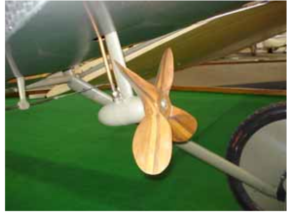
DH-1: Luftgetriebene Benzinpumpe.
