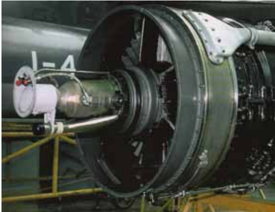
Starterturbine „Plessey“ vorn am Kompressor angeflanscht. Das Betriebsmittel war Isopropylnitrat, (ein Raketentreibstoff, hoch giftig)
