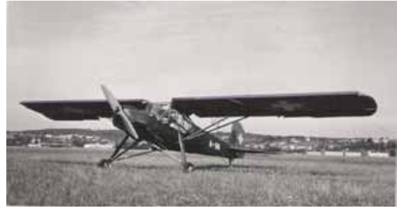
1940: Fi-156 C-3 Trop, „Fieseler Storch“. Durch Internierung und Erwerb sowie durch Zukauf kamen total 5 Flz Fieseler zur Fliegertruppe. Das Flugzeug hatte ausgesprochen gute Langsamflugeigenschaften, weshalb er sich für den Einsatz im unwegsamen Gelände und im Gebirge sehr gut eignete.
