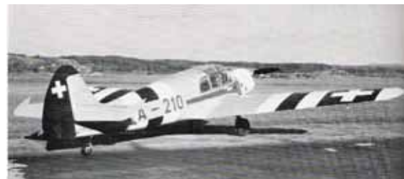
1938: Messerschmitt Me-108 B „Taifun“. 18 Flz wurden von Messerschmitt abgeliefert. Sie dienen für das Umschulen auf die Flz Me-109, aber vor allem für Verbindungs- und Reiseflüge.
