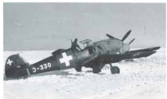
Warmhalten eines Flz Me-109E mit Wärmedecken und im Sack (unter dem Rumpf) Katalyten
