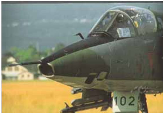
„Mirage“ III RS: Die Öffnungen für die Kameras sind sichtbar (vorn, seitlich und unten)
