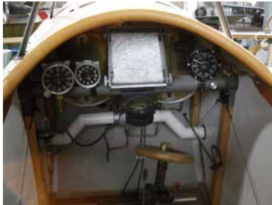
Instrumentenbrett Blériot: Drehzahlmesser, Borduhr, Höhenmesser, Kompass
