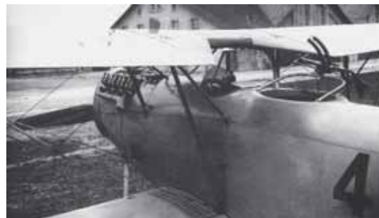
DH-5: Für den Beobachter war eine Doppelpistole auf einer drehbaren Lafette montiert.
