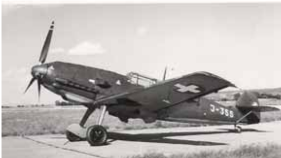
1938: Messerschmitt Me-109E-3 „Emil“. 80 Flz wurden von Messerschmitt geliefert, 30 noch vor dem Krieg, der Rest Anfang 1940. Das Flz hatte einen Motor DB- 601 von 1100 PS. Nach dem Krieg baute Doflug noch 8 Flz aus Reserveteilen.
