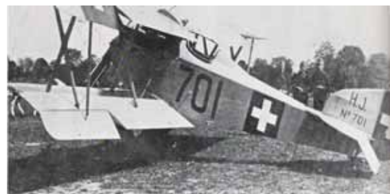
1918: DH-4 (Häfeli) Verkleinertes Flz DH-3 mit kleineren Tragflächen. Die Leistungen befriedigten nicht.
