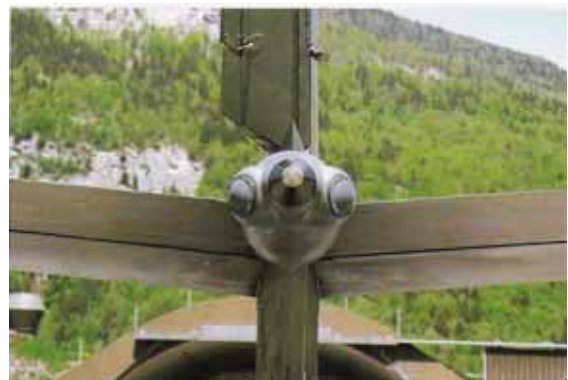
Flugzeug „Hunter“: Die Antennen des Warnradars im Heck des Flugzeugs. Vorne am Bug sind zwei gleiche Antennen angebracht
