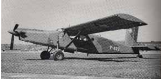
1976: Pilatus-Porter PC-6 B2-H2M. Es wurden 6 Flz beschafft, motorisiert mit einer Pratt & Whitney Propellerturbine von grösserer Leistung.
