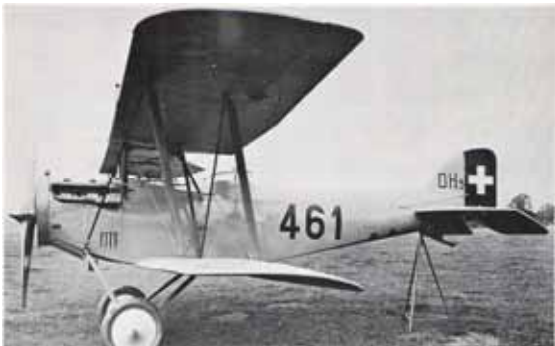
1924: DH-5 (Häfeli) mit leichterem Motor. Statt LFW II mit 238 Kg, den Typ HS-41 mit 150 kg Die Änderung brachte keinen Gewinn.
