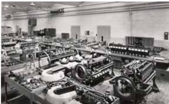
Motorenwerkstatt: HS-51 und RR V-1650 in Buochs
