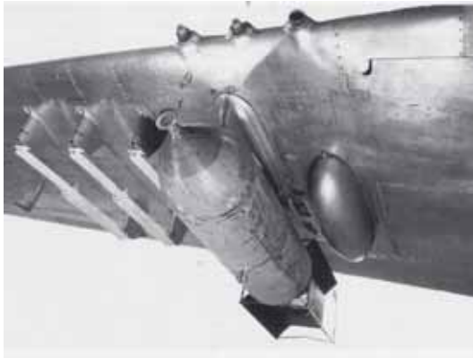
P-51 „Mustang“: 3 Maschinengewehre in jedem Flügel. Sicht von unten. Die 3 MG-Mündungen oben in der Eintrittskante
