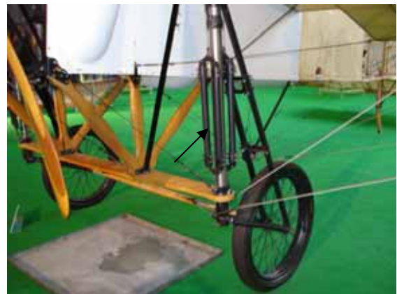
Abfederung beim Flz „Blériot“. Je Fahrwerkseite 4 Gummistrippen
