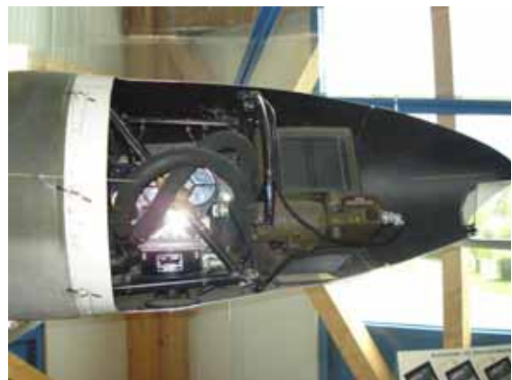
Foto- Flunt: Vorderer Teil mit Kameraausrüstung.
