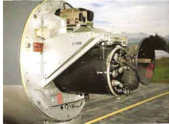
Der Radar-Distanzmesser im Flugzeug „Hunter“
