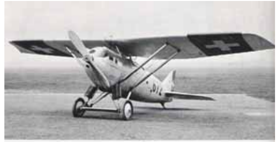
1926: Devoitine D-1 C-1. HS-42 (300 PS). 2 Flugzeuge wurden in Frankreich beschafft. Die Flugleistungen befriedigten nicht. Das Flugzeug war zu schwer für diesen Motor.
