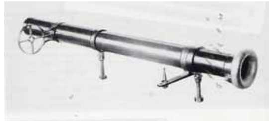
Der „Collimateur“: Ein Fernrohr und daneben ein offenes Ringvisier
