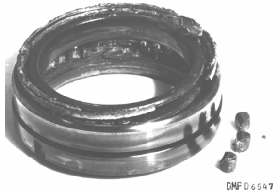
„Ghost“: Kugellager zu Rotorwelle defekt.
