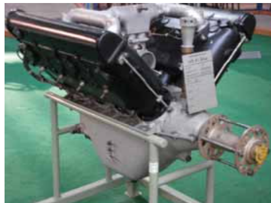
HS-41: Lizenzbau von Hispano- Suiza bei SLM, Winterthur, 150 PS (DH-3)
