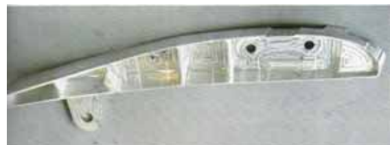
Flügelprofil aus einem Block gefräst.
