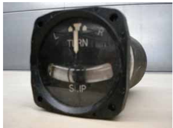
Der Wendezeiger: Kombiinstrument aus Libelle und Wendezeiger. Standard ab C-35
