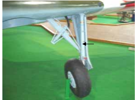
Einzieh-Fahrwerk D-3800/01. Einfahren nach innen. (Der Stossdämpfer ist im Federbein integriert)
