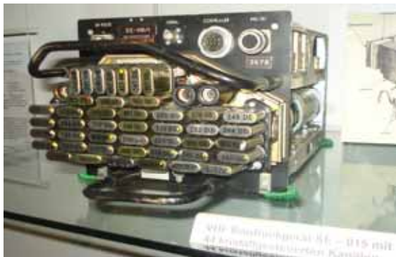
SE 015, Die Flz-Serien DH-100 und DH-112 wurden mit diesem Gerät bestückt. (10 vorabgestimmte Kanäle)
