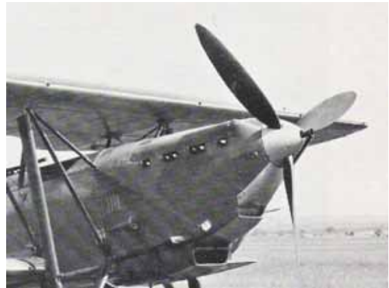
C-35: „Ratier“-Propeller, Metall fest.
