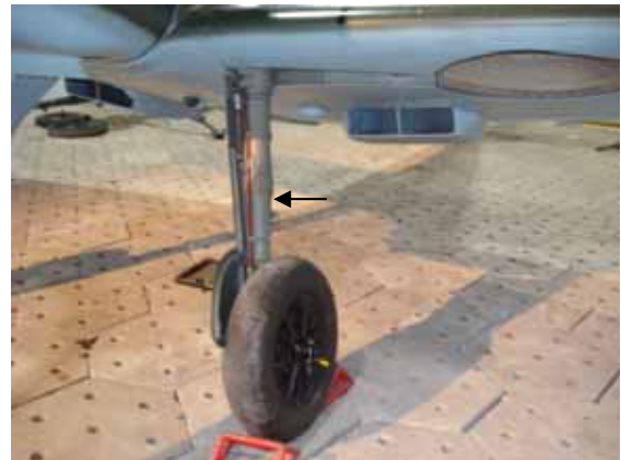
Me -109E. Einfahren nach aussen in den Flügel
