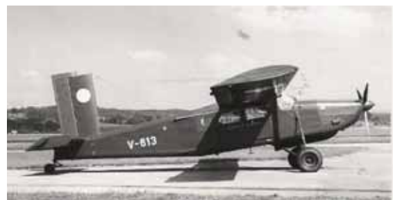
1967: Pilatus-Porter PC-6/H2M. Es wurden 12 Flz beschafft. Das Flz war mit einem Kolbenmotor ausgerüstet und diente für Transporte sowie für die Ausbildung der Fallschirm-Grenadiere
