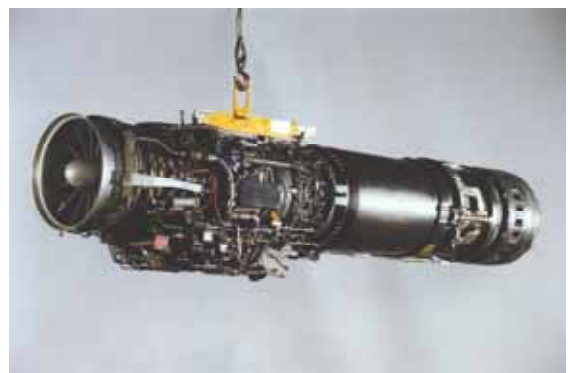
J-85-GE-21: 1588 kg Schub ohne Nachbrenner; 2268 kg Schub mit Nachbrenner („Tiger“ II F-5E und F). Einwellen-Einstromtriebwerk.
