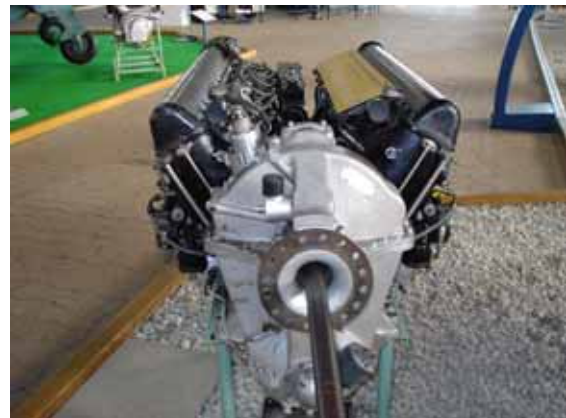
Die Motorkanone zwischen den Zylinderblöcken liegend. Der Lauf geht mitten durch die Propellernabe
