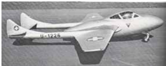
1953: De Havilland DH-115 Mk 55 „Vampire Trainer“. Bis 1967 wurden total 39 Flugzeuge beschafft . Die Flz stammten aus Beständen der Royal Air Force RAF und wurden in Zusammenarbeit zwischen De Havilland und F+W Emmen umgebaut.
