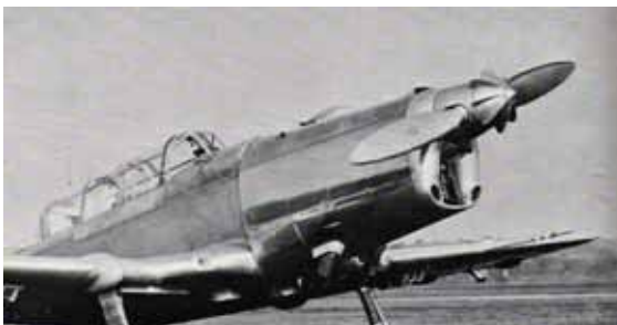
Pilatus P2: Der Propeller System Argus wurde durch Luftkraft des vorne auf der Haube montierten Impellers verstellt.
