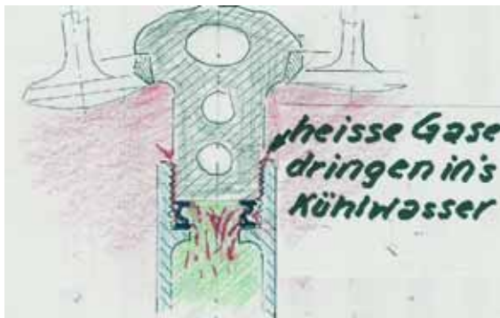
Hier drangen die heissen Gase vom Verbrennungsraum in den Kühlmantel.
