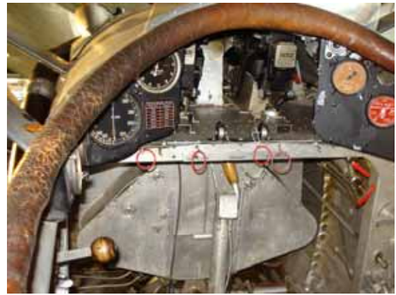
D-27: Das Flz besass nur einen Höhen- und Geschwindigkeitsmesser, einen Drehzähler sowie eine Öl- und Wassertemperaturanzeige
