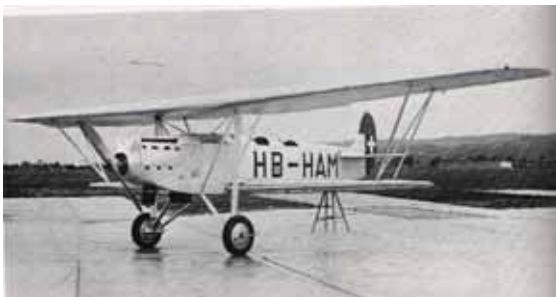
1934: Fokker CV-E Tr. K+W, Thun. 7 Flz mit dem schwächeren Motor HS 57 wurden gebaut. Diese Flugzeuge dienten zum Schulen und für Reisen.
