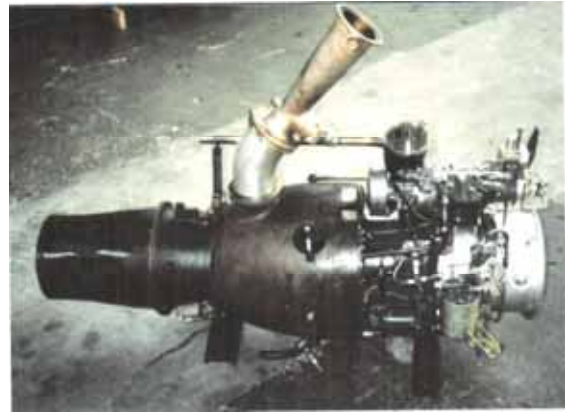
„Palouste“ IV: 240 PS. SO.1221 S („Djinn“). Der Stutzen für die abgezapfte, verdichtete Luft zu den Rotorblättern führt vom Kompressor nach oben.
