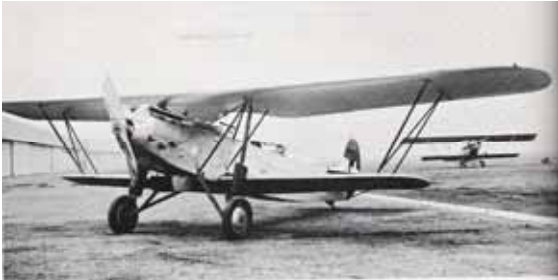
1932: Fokker C-IX mit HS-61 (650 PS). Mit hinten hochgezogenem Rumpf und verstärktem Fahrwerk.
