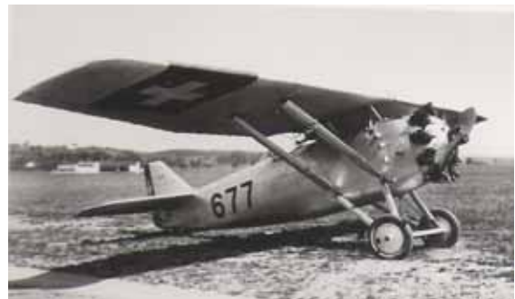
1928: Devoitine D-9 C-1 Jupiter 9 AB (420 PS). 3 Flugzeuge wurden in Thun zusammengebaut. Gleiche Zelle wie das Flz D-19.
