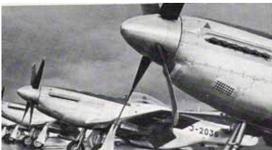
P-51 „Mustang“: Dieser riesige „Hamilton“-Constantspeed“-Vierblattpropeller wurde ebenfalls hydraulisch verstellt
