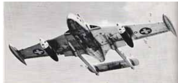
DH 112-Aufklärer: Unter den Flügeln die Fotoflunt, im weissen Teil die Fotoanlage
