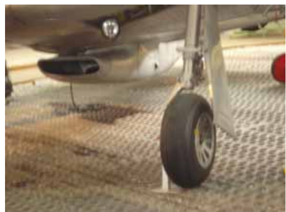
P-51 „Mustang“: Einfahren nach innen in den Flügel
