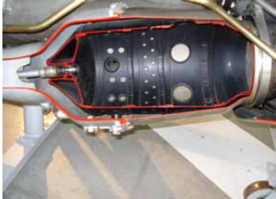
„Ghost“: Schnitt durch die Brennkammer.
