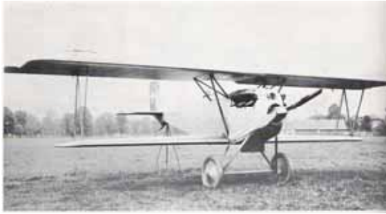
1924: MA-7 (Häfeli), mit HS-42 (300PS) Holzrumpf aber Tragflächen wie das Flz Fokker DVII Auch dieses Flugzeug befriedigte nicht.
