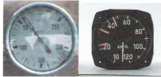
Der klassische Geschwindigkeitsmesser Links: DH-3 Rechts: „Hunter“. Die angezeigten Zahlen sind mit 10 zu multiplizieren
