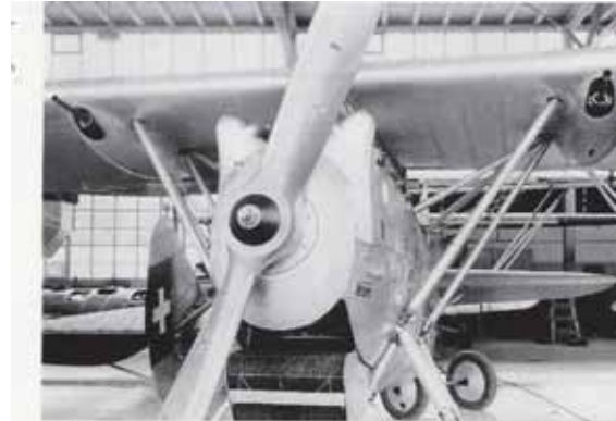
Devoitine D-27 mit je einer 20 mm Oerlikon Kanone unter dem Flügel.
