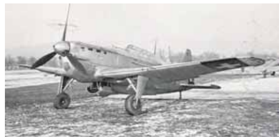
1939: Morane-Saulnier MS-406C-1. HS-12 Y (860 PS). Die Flugeigenschaften waren gut, so dass sofort mit dem Serienbau durch das F+W Emmen begonnen wurde.
