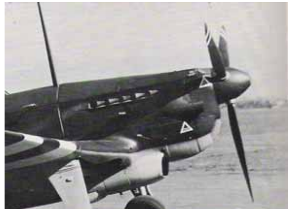
D-3800/01 und C-3603: Escher-Wyss. Constant-speed, Metall (wurde hydraulisch verstellt)
