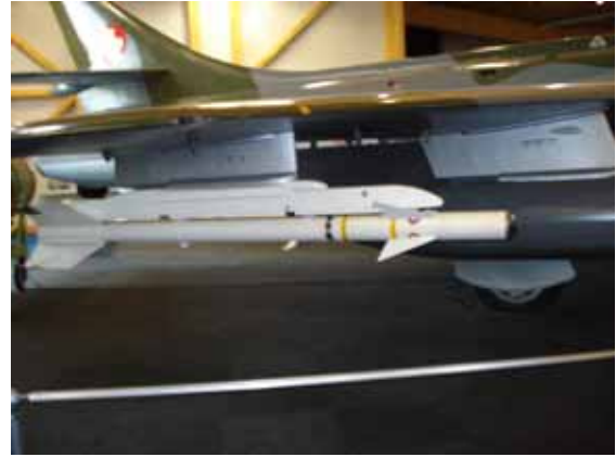
„Sidewinder“: Lenkwaffe mit Infrarot -Suchkopf
