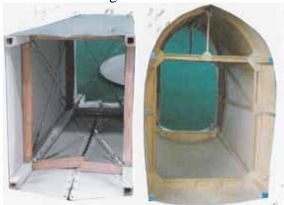
Drahtverspanntes Holzgitter mit Stoffüberzug
