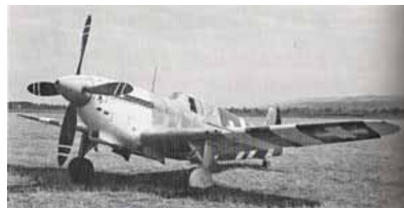
1947: D-3802 „Morane-Saulnier“ MS-540 Es wurden 12 Flz durch die FFA, Altenrhein in Lizenz gebaut. Dieses Flz. war ausgerüstet mit einem Saurer Y2-Motor von 1250 PS. Der Motor hatte erst wenige Betriebsstunden und war deshalb noch ziemlich störanfällig. Zudem waren ja schon die ersten
