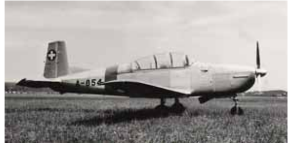
1956: Pilatus P3-05. 60 Flugzeuge wurden durch die Pilatuswerke in Stans, das F+W Emmen und Doflug gebaut. Sie lösten die Flz Bücker 131 und P2 als Schulflugzeuge ab.
