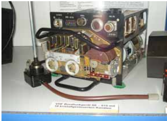
Das Funkgerät SE 012 ging aus dem STR 9 hervor (4 vorabgestimmte Kanäle)
