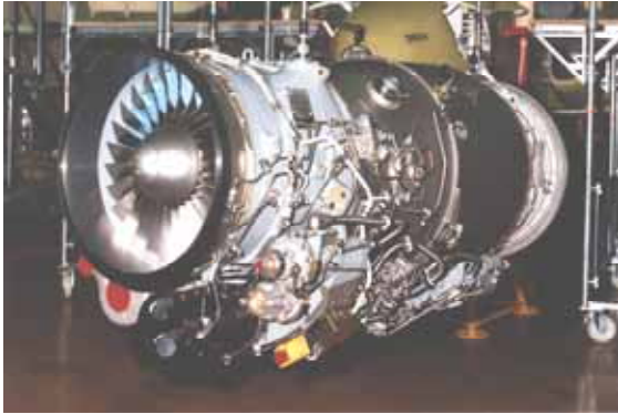
„Adour“ Mk.661 A03: 2535 Kg Schub. (Hawker „Hawk“ Mk 66); Zweiwellen-Zweistrom Triebwerk.
