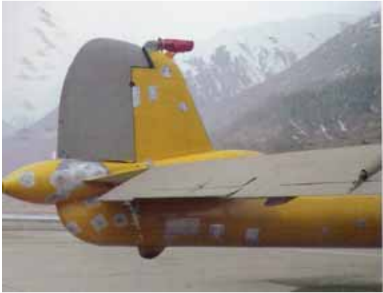
Reparaturen durch die Truppe an der Zelle eines FZ DH-112 nach Beschuss
