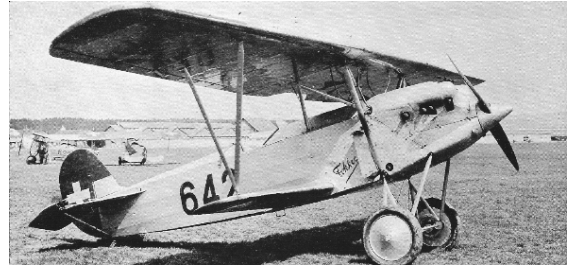
1925: Fokker DXI („Wildsau“) HS-42 (300 PS). Das Flugzeug eignete sich aber nicht, da bei Start und Landung und im Kurvenkampf zu „gefährlich“.
