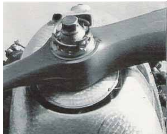
An der Propellernabe vorn war eine Klaue montiert, an welchem der Propellerwagen einhängen konnte.
