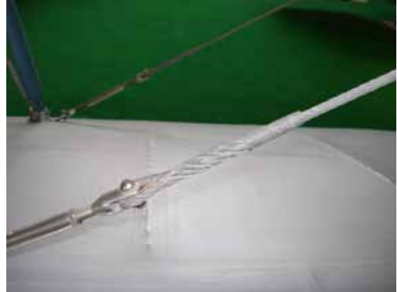
Ein Spleiss an der Schlaufe des Seils
