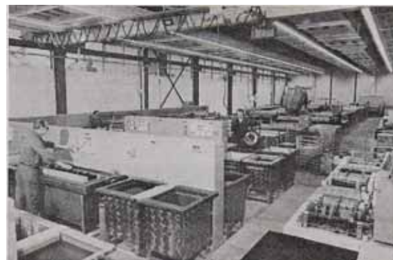
Oberflächenwerkstatt: Hier wird verchromt, aufgeschromt, cadmiert, versilbert, anodisiert etc
