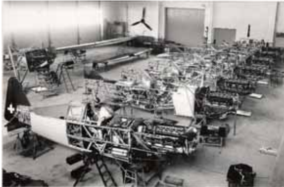
Revisionsarbeiten an Flz „Morane“ D3800/01 in Interlaken, der Fachstelle für dieses Flugzeug
