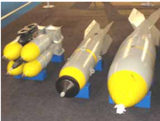
Bomben neueren Typs, wie sie beim Flz DH- 100/112 und danach verwendet wurden. Links ein Bündel von 4x50 kg Bomben, in der Mitte eine 200 kg Bombe, rechts eine 400 kg Bombe
