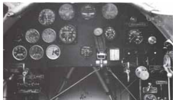
C-35: Oben sind der Wendezeiger mit Libelle und das Variometer zu erkennen.
