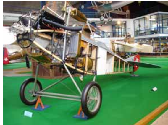
DH-3, Holzgitterrumpf mit Stoff bespannt
