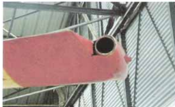
Djinn: Rückstossdüse am Ende des Rotors
