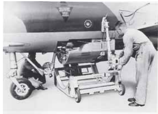
„Hunter“: Die 4 30 mm Aden-Kanonen waren unten im Rumpf eingebaut. Zum neu Beladen konnte die ganze Waffenwanne entfernt und durch eine geladene Wanne ersetzt werden
