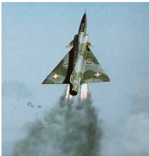
„Mirage“-Start mit „Jato“- Startraketen
