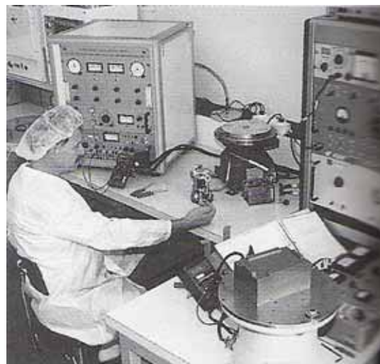
Prüfung eines Hydraulikgerätes auf dem Prüfstand
