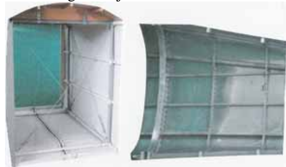
Drahtverspanntes Stahlrohrgitter mit Stoffbespannung
