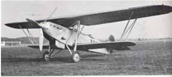
1932: Fokker CV-E mit HS-72 (860 PS mit Höhenlader).
