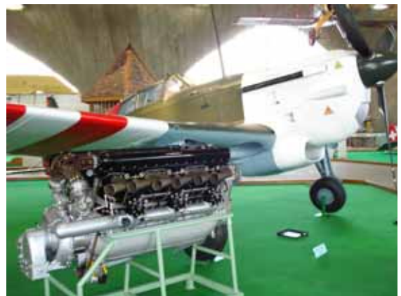
HS- 77, 860 PS (D-3800) und HS- 51, 1000 PS, (D-3801) unterschieden sich hauptsächlich im Zylinderinhalt.
