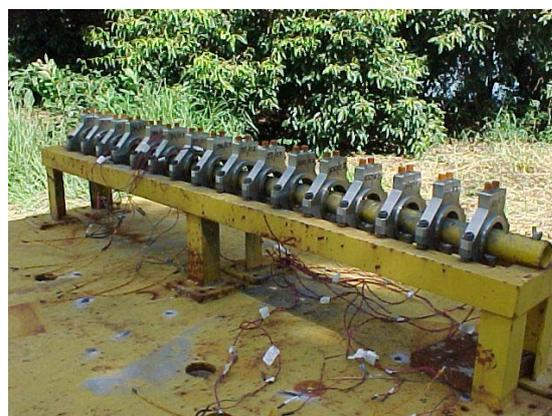
Figura 18 - Teste de pirotécnicos do sistema de separação do primeiro estágio.
