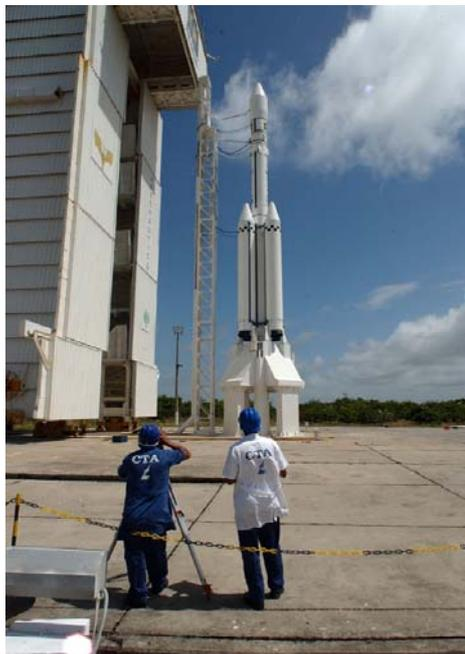
Figura 32 - Verificação da verticalidade do Veículo.
