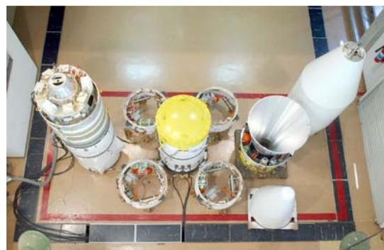
Figura 17 - Teste das redes elétricas integradas.
