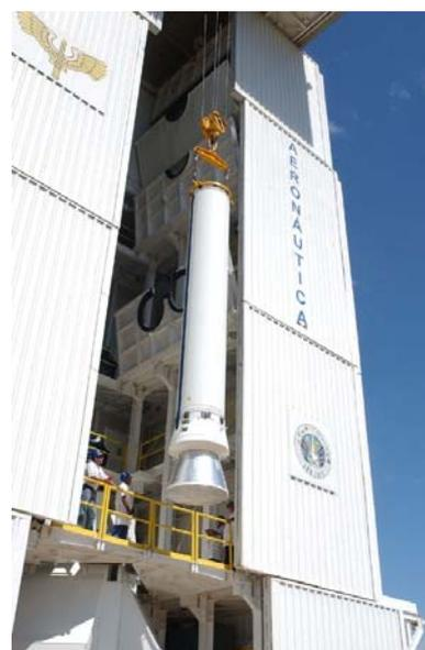
Figura 23 - Içamento para integração do segundo estágio.
