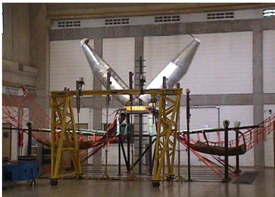
Figura 19 - Teste de separação da coifa principal.
