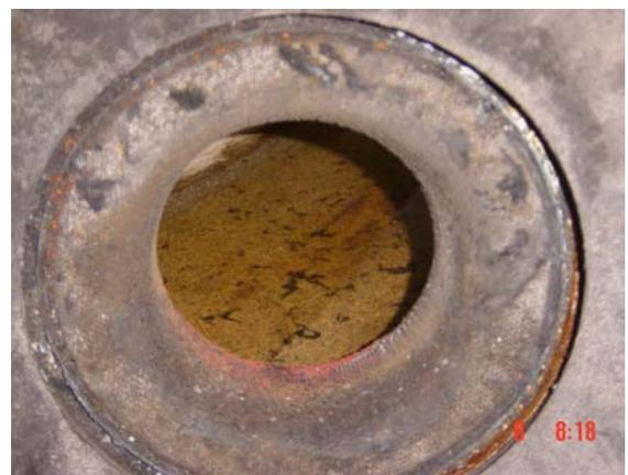
Figura 55 - Garganta do propulsor A do primeiro estágio.
