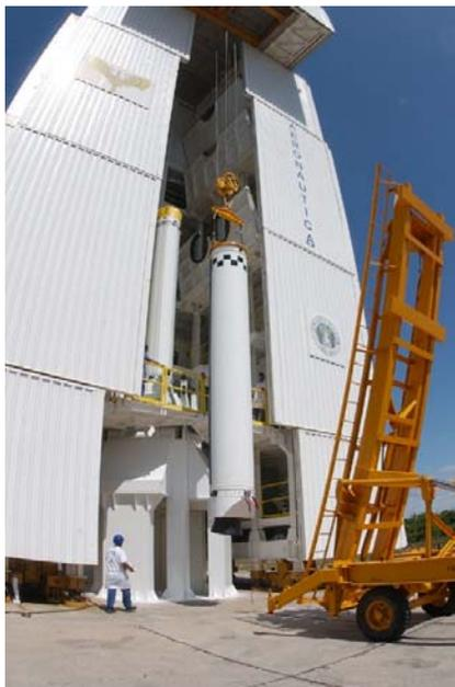
Figura 24 - Içamento para integração do primeiro estágio.
