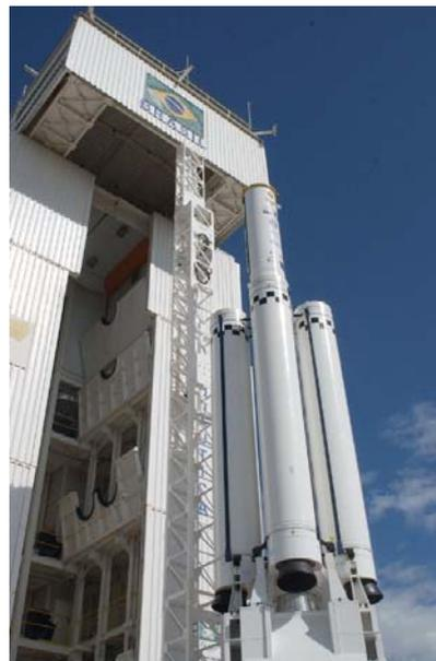
Figura 26 - Terceiro estágio já acoplado no VLS-1 V03.
