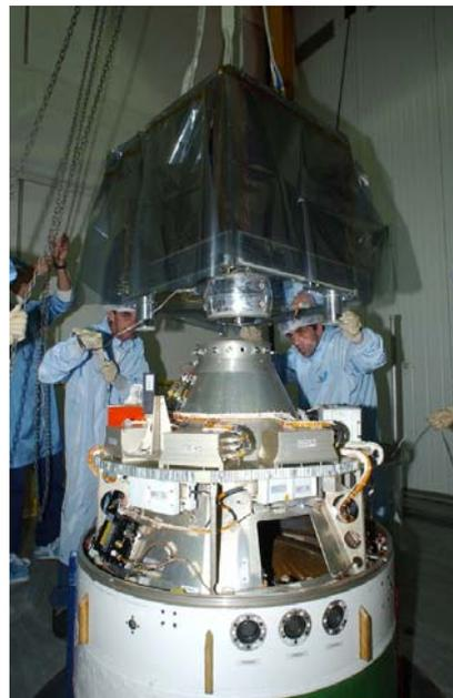
Figura 30 - Acoplamento do satélite ao Veículo.
