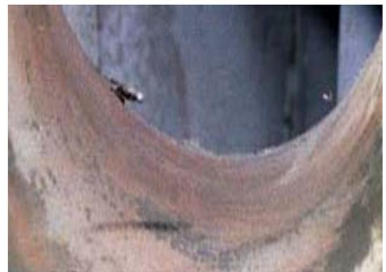
Figura 54 - Detalhe do inserto carbono-carbono da garganta do propulsor do segundo estágio.
