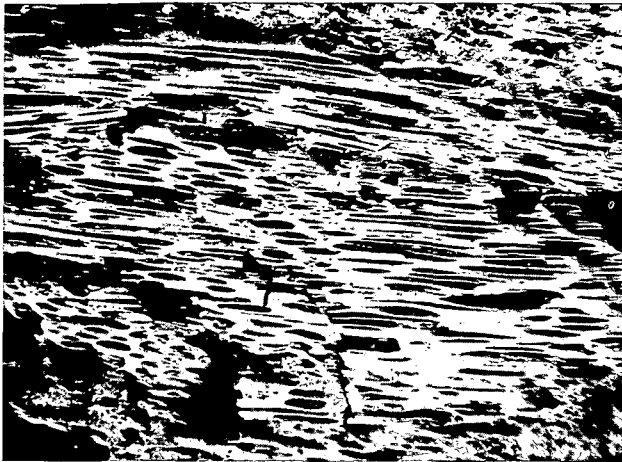
Bild 1. Rußkohle des Rußkohlenflözes der Altgemeinde-Schächte in Zwickau. Schnitt parallel der Zellstruktur der fossilen Holzkohle. Die Zellen sind hohl. Vergrößerung: 55 X.
