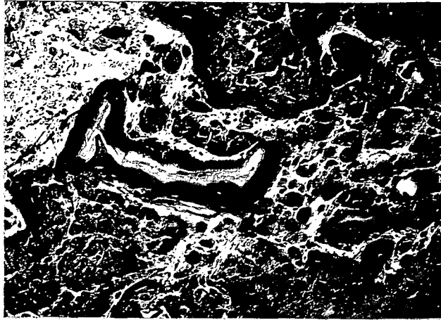
Bild 3. Makrospore und sich verästelnder Vitrit. Unbenanntes Flöz, Gottes Hilfe-Schacht in Ölsnitz. Schnitt parallel. Die Makrospore zeigt die Mediannaht. Der sich verzweigende Vitrit ist aus Lösung abgesetzt. Vergrößerung: 55 \times .
