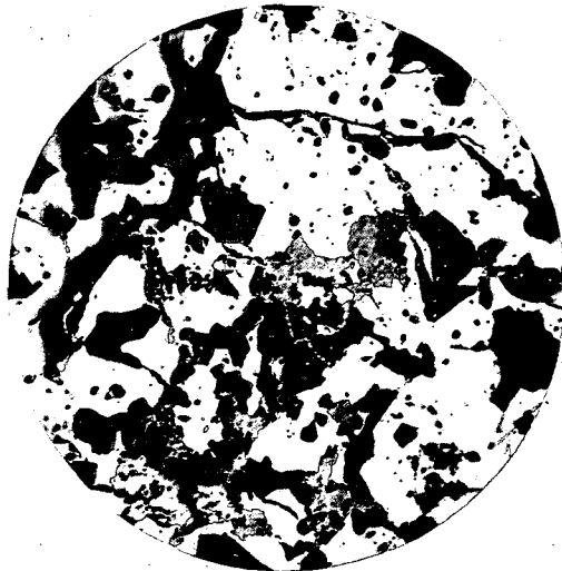
(Abb. 3.) Polierter Anschliff, ungeätzt; Vergr.: 43 × Innige Verwachsung von Magnetit (weiß, löcherige Oberfläche); Lagergestein Salit und Granat (hell- und dunkelgrau).
