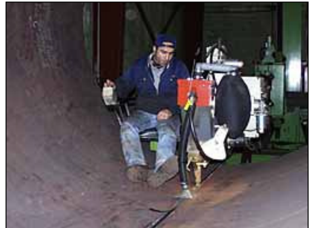
Zusammenschweißen der Segmente
