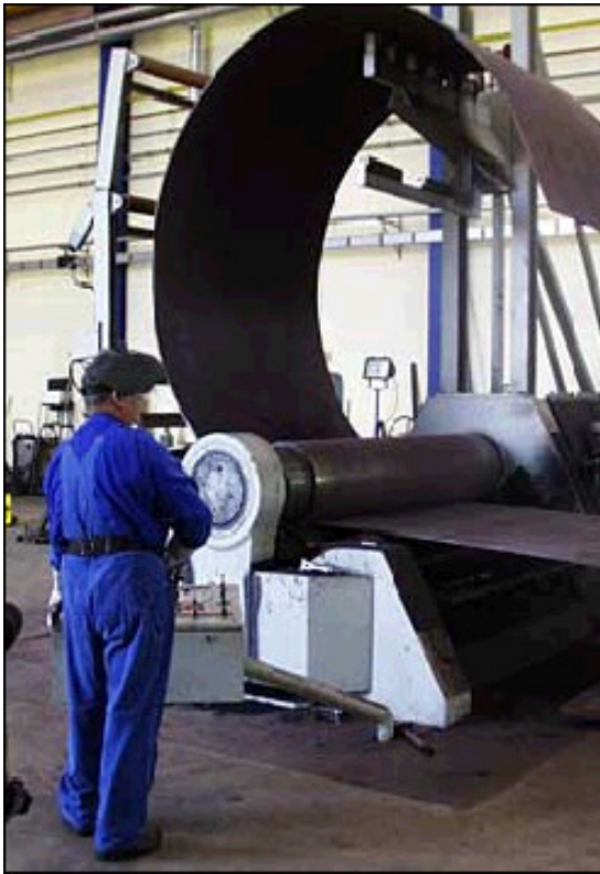
Biegen der Turmsegmente
