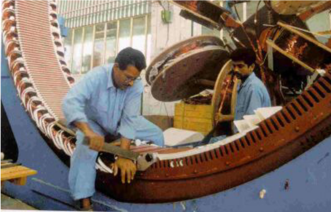
Wickeln des Stators
