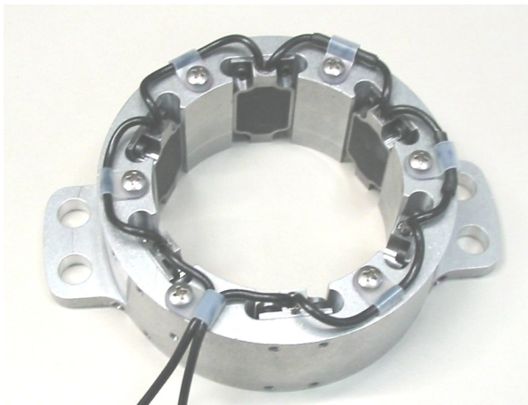
Montagering bestückt mit 6 Sensorköpfen ACC 22 zur Messung der Beschleunigung eines hochdynamischen Hydraulikzylinders aus Titan
