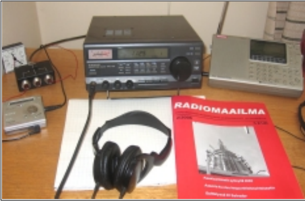
Kuvassa keskellä harrastajan liikennevastaanotin, oikealla maailmanradio ja vasemmalla edessä ohjelmien tallennukseen MiniDisc-soitin.
