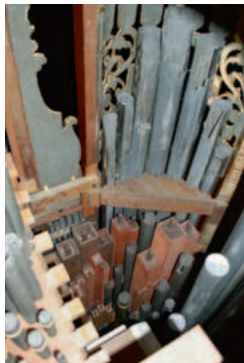
Gezicht van binnenuit op de linker overhoeks gedraaide toren, de bovenwerkklade (uiterst links) en de hoofdwerkklade met pedaalpijpwerk direct achter het front.
