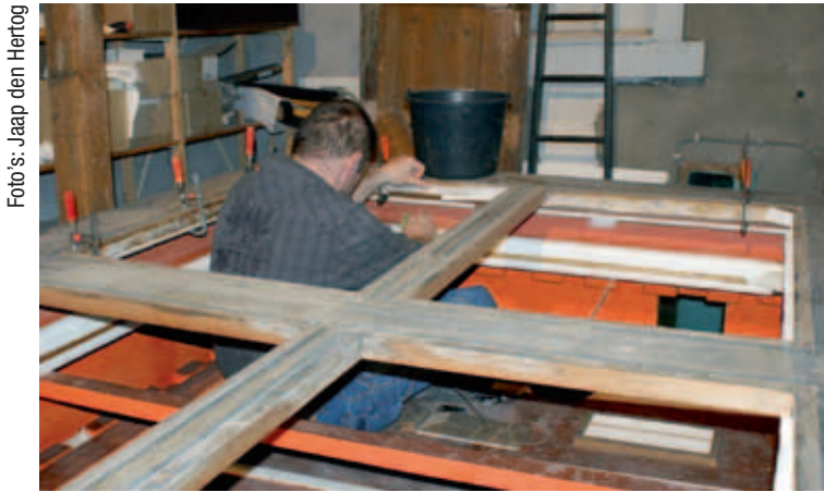
Een medewerker van Verschuieren bezig met de restauratie van de degelijke magazijnbalg van Bik.
