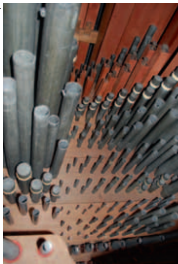
Gezicht op de bovenwerkklade. Ook hier is het houten pijpwerk tussen front en lade goed te zien.
