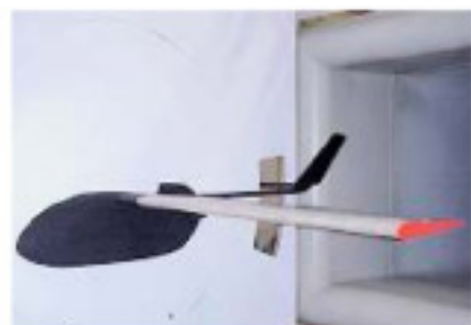
ANTEX-M X00, em teste no túnel aerodinâmico da Academia da Força Aérea
