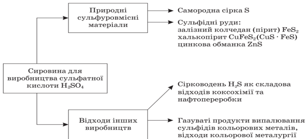
Рис. 1. Схема сировини для виробництва сульфатної кислоти [3]
