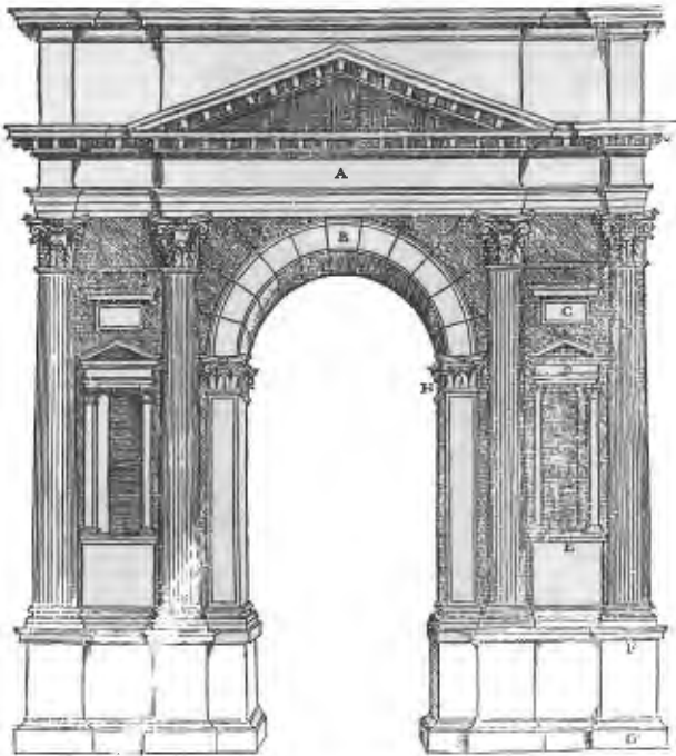
3. El esquema compositivo de Serlio para las portadas, basado en el Arco del Triunfo. De Serlio, Tercero y Cuarto libro de architectura .
