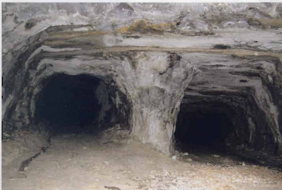
Nella miniera di Santo Spirito, all'ingresso della prima galleria, si incontrano altre due che scorrono quasi parallele tra loro. La colorazione della roccia evidenzia la presenza di materiale asfaltico. (foto D. Di Matteo)
