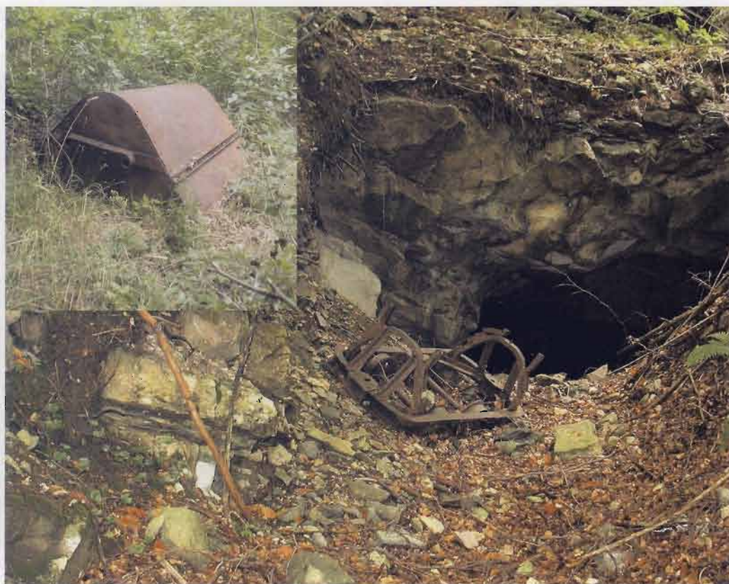
Carrello ribaltabile per il trasporto della roccia, abbandonato in uno degli ingressi della miniera di S. Spirito. Questi carrelli venivano introdotti nelle gallerie, tramite rotaie, per il carico di materiale. (Foto C. Iacovone)
