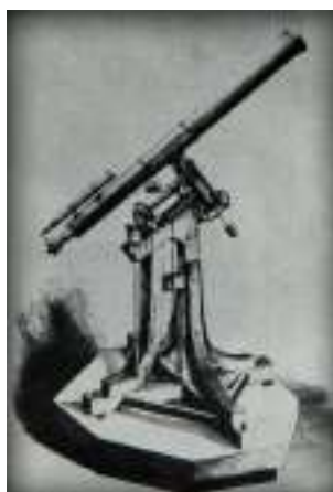
El refractor ecuatorial de 16.5 cm usado por Gilliss y Moesta
