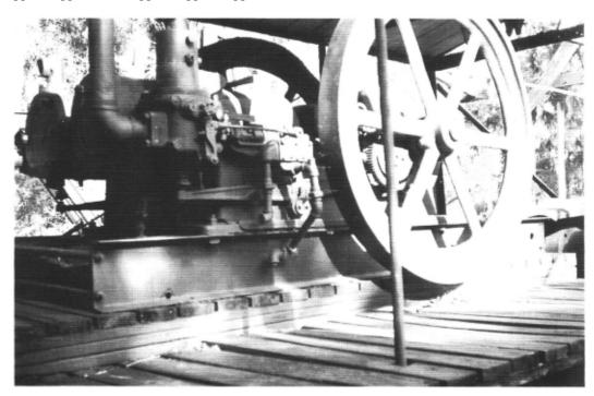
FIG. 4 - 50H.P. TWIN CYLINDER MULTI-FUEL ENGINE
