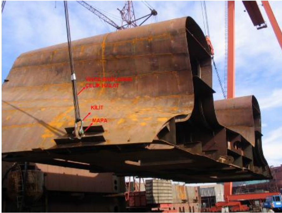
Resim 1.9: Blok kaldırma operasyonu
