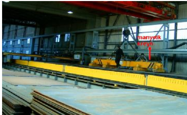
Resim 1.2: Manyetik kreyn ile sac plaka taşınırken
