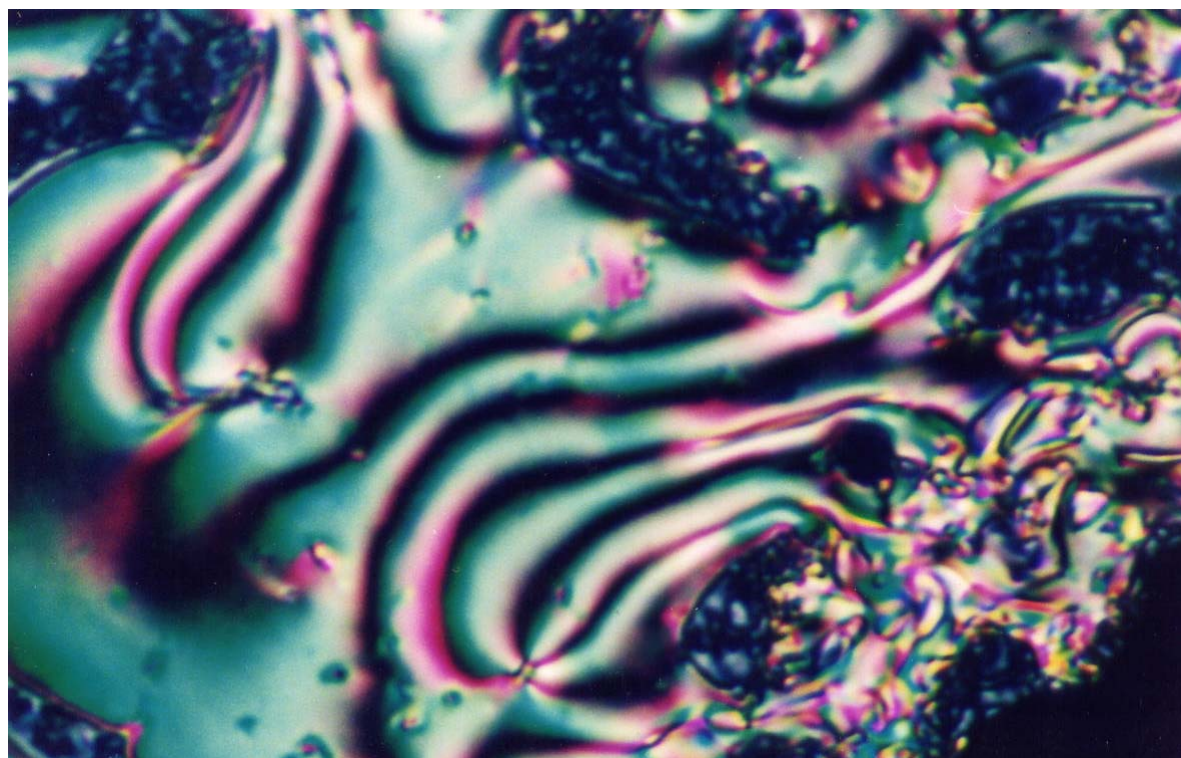
Fig. 4-50 ANA-BDO-TPA 在 300°C 之 photomicrograph (倍率 240)
