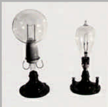
Thomas Alva Edisons Glühlampen in Platindraht- und Kohlefadenversion, noch ohne den typischen Schraubsockel.
