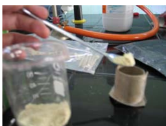
Carregant de compost inflamable el cilindre de cartró.
