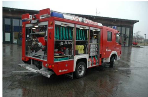
BILD 6.3 TSF-W (zgM = 7,49 t) mit "Kommunalkabine", Stromerzeuger, Beleuchtungssatz, Tauchpumpe und Kettensägensatz (Ausführungsbeispiel)
