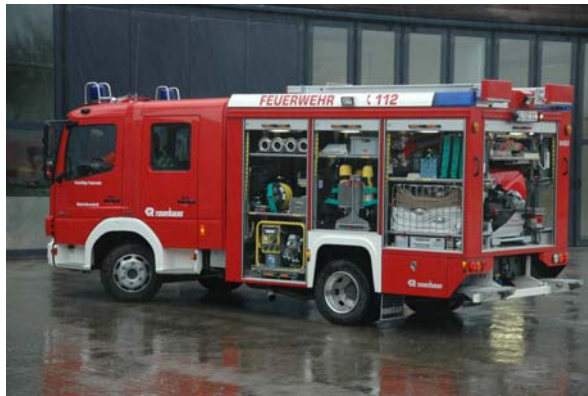
BILD 6.3 TSF-W (zgM = 7,49 t) mit "Kommunalkabine", Stromerzeuger, Beleuchtungssatz, Tauchpumpe und Kettensägensatz (Ausführungsbeispiel)
