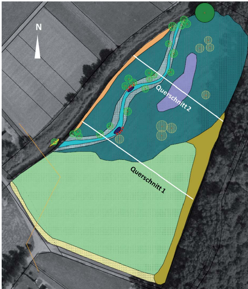
Abb. 1: Schematische Darstellung der Pfennigerwiesen nach der Renaturierung mit den Berechnungsquerschnitten 1 und 2 (nach Lehmann, 2005).
