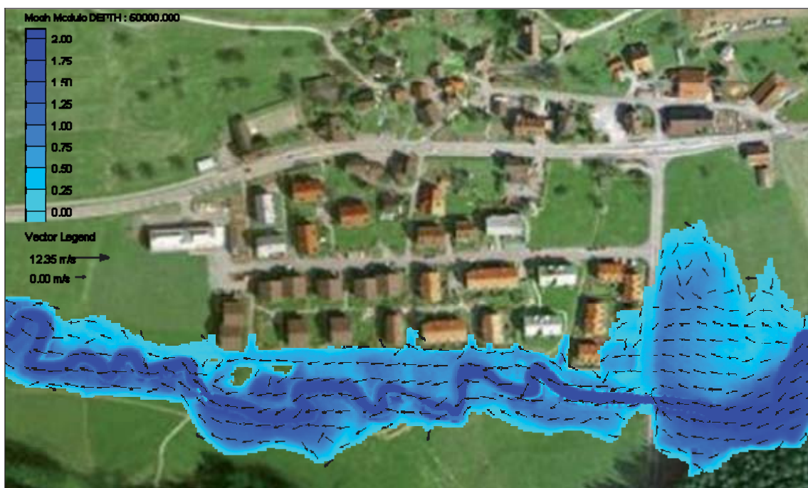
Abb. 3: Satellitenbild (Google Earth), überlagert mit Wassertiefen und Geschwindigkeitsvektoren (EHQ), Stallikon.
