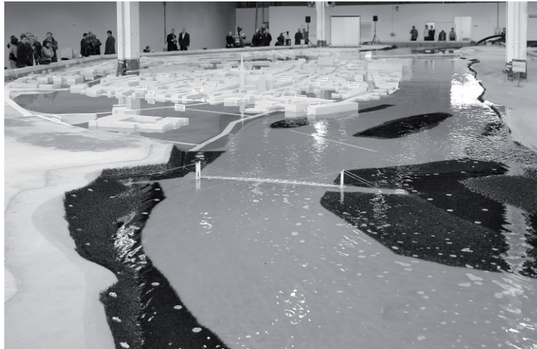
Abb. 4: Physikalischer Modellversuch M 1:50 [Quelle: UJ K. Eckhold].
