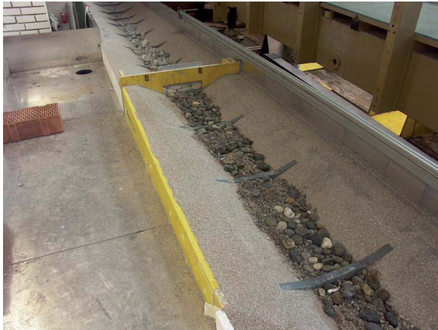
Abb. 6: Entlastungsbauwerk im physikalischen Modell des IWI: hier für einen untersuchten Fall mit Querbauwerk.
