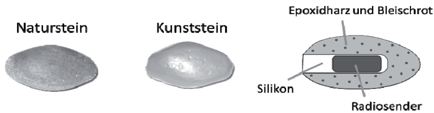
Abb. 3: Naturstein im Vergleich mit Kunststein und Bauweise.
