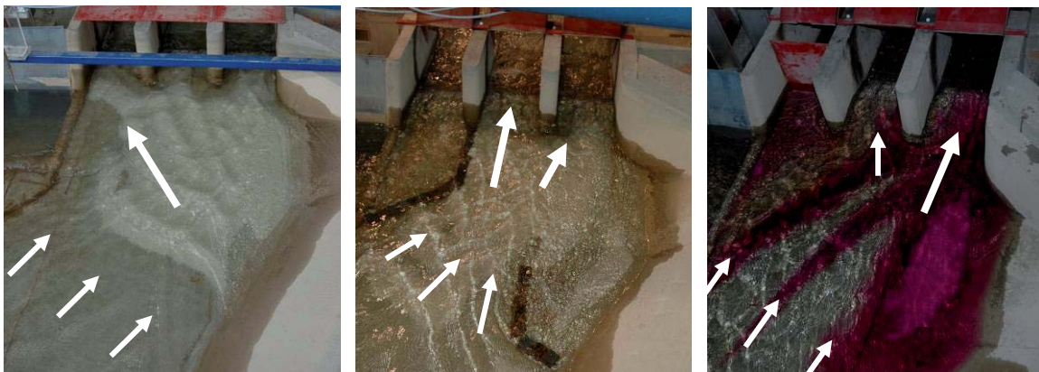
Abb. 5: Wehrfelder OW-seitig: Ausgangszustand (links), Leitwerke (Mitte), geschlossenes.
