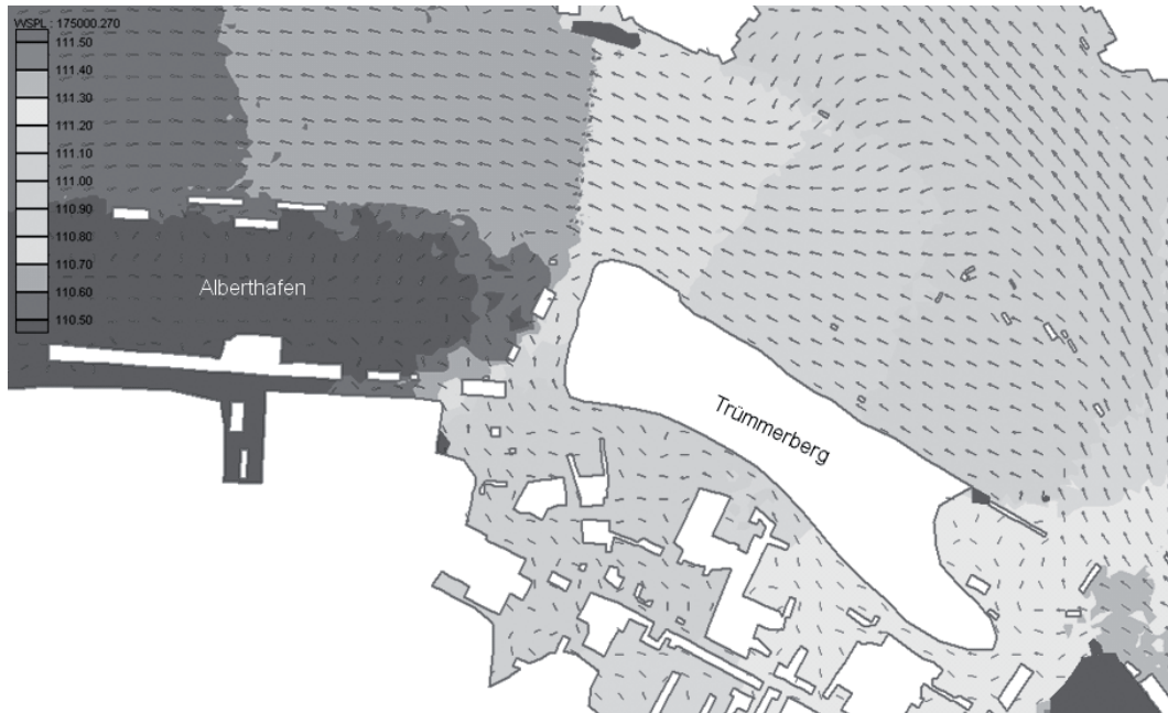
Abb. 3: Strömungssituation zwischen Trümmerberg und Hafen (ohne Verbau, HQ100).
