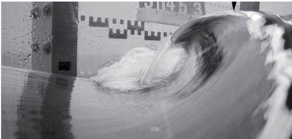
Abb. 2: Wellenröhre im physikalischen Modell.
