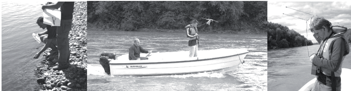
Abb. 4: links: Einsatz der Tracer am Ufer, Mitte: Suche der Tracer vom Boot aus, rechts: Antenne und Empfangsgerät.
