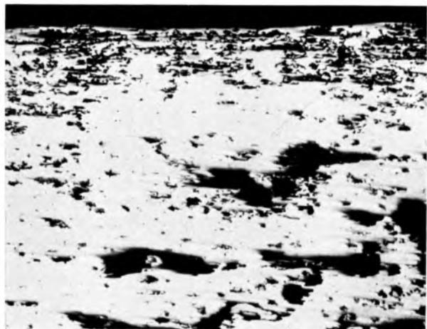
Abb. 16. Avional Z, 3 mm Blech, Vorkühlzeit 40 sec. 3 Tage in salzsaurer NaCl-Lösung korrodiert. — V = 60.
