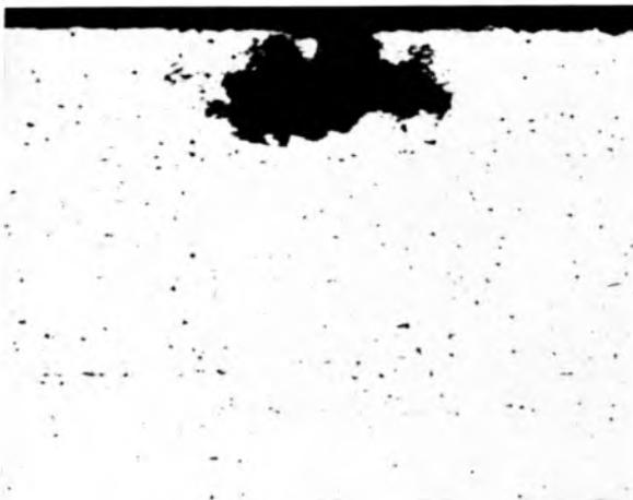
Abb. 8. Avional D, 1 mm Blech, in Wasser von 4° C abgeschreckt. 3 Tage in salzsaurer NaCl-Lösung korrodiert. — V = 60.
