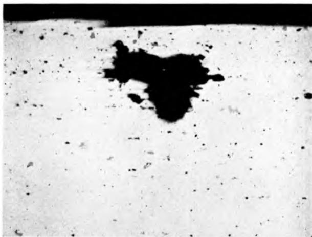
Abb. 3. Avional Z, 1 mm Blech, nach einer Vorkühlzeit von 1 sec in Wasser von 15° abgeschreckt. 3 Tage in salzsaurer NaCl-Lösung korrodiert. — V = 150.
