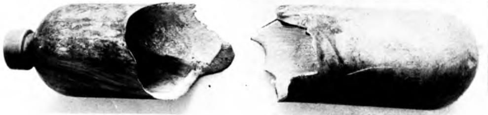
Abb. 19. Durch eine Gewehrkugel durchschlagene, zum Teil verbrannte Aluminium-Sauerstoffdruckflasche.
