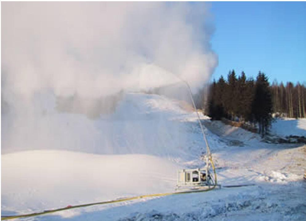
Kuva 22. Suoralumetukseen soveltuva hybriditykki 75
