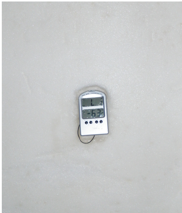
Kuva 16. Digitaalinen sisä-/ulkolämpömittari lumirakenteessa 64
