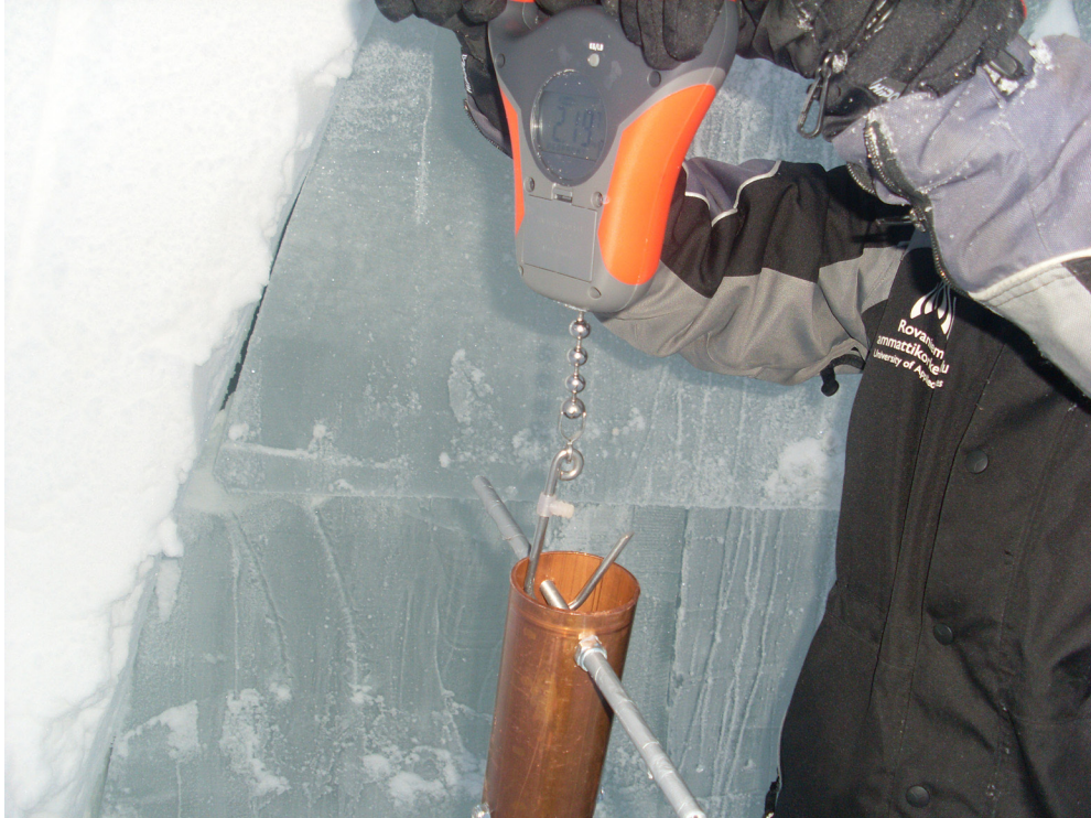
Kuva 19. Lumentiheyden mittaaminen putken ja vaa'an avulla 68
