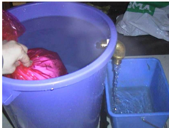
Kuva 18. Luminäytteen tiheyden määrittäminen upotuskokeella 67
