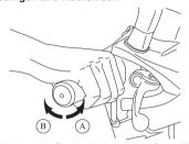
Zum Erhöhen der Geschwindigkeit den Gasgriff in Richtung (A) drehen. Zum Verringern der Geschwindigkeit den Gasgriff in Richtung (B) drehen.
