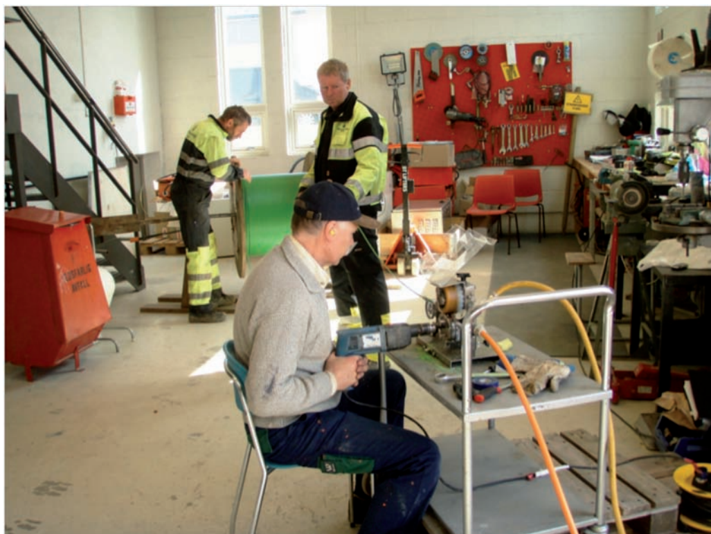
Blåsing av fiber. Birger Slupstad styrer blåseprosessen med assistanse av Hallgeir Olsen (tv) og Idar Sørлие.
