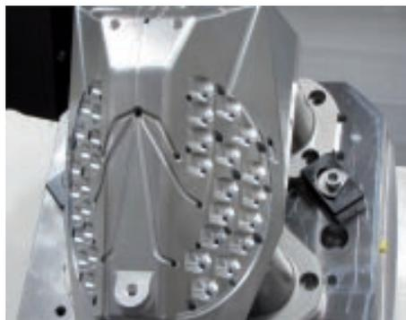
Bild 4: Formeinsatz für den Reflektor einer LED- Strassenlaterne auf einer CNC-Fräsmaschine Mikron HPM 800U HD (Quelle: HBW-Gubesch und GF AgieCharmilles)
