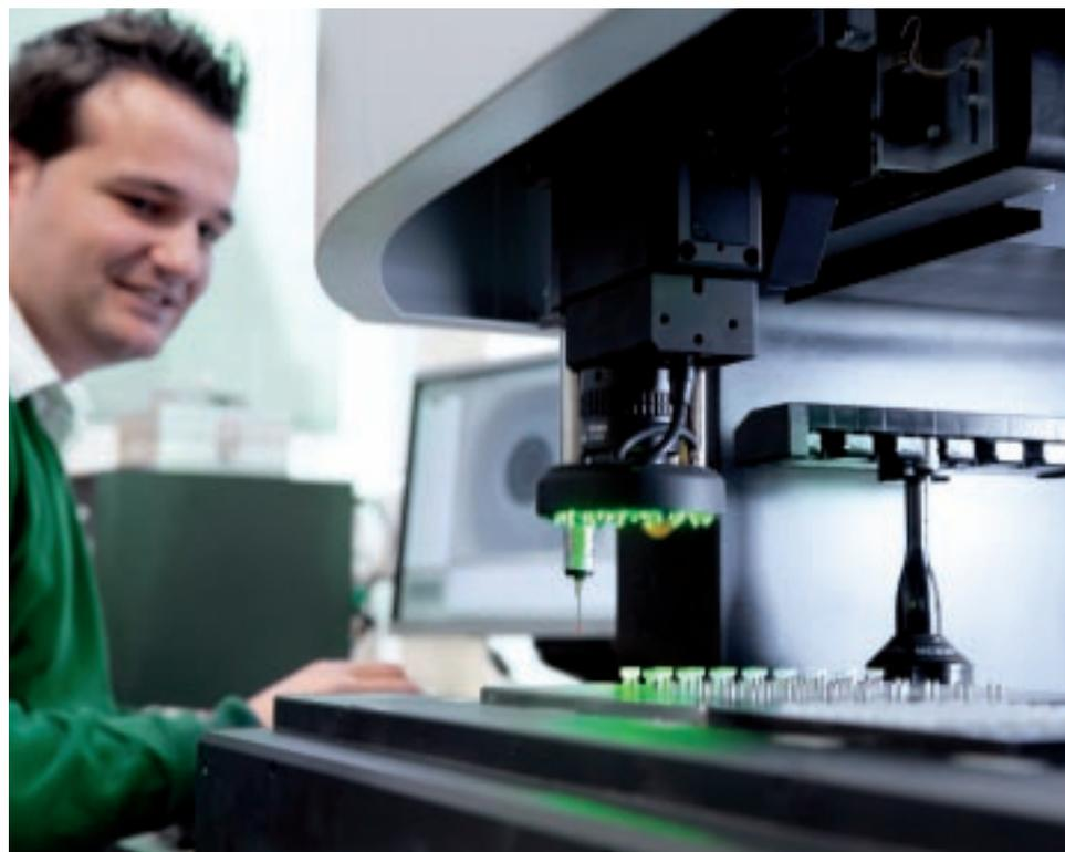
Optische Vermessung eines Bauteils des Tiomos Dämpfungszyinders (32-fach Werkzeug) bei Grass.
