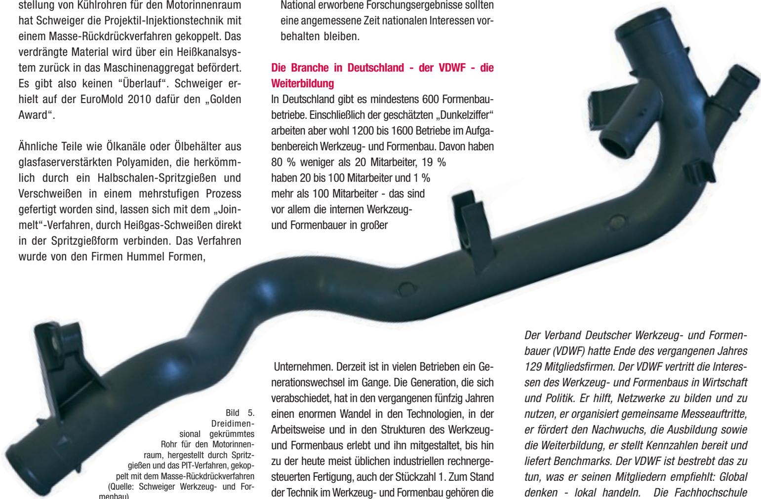
Bild 5. Dreidimensional gekrümmtes Rohr für den Motorinnenraum, hergestellt durch Spritzgießen und das PIT-Verfahren, gekoppelt mit dem Masse-Rückdruckverfahren (Quelle: Schweiger Werkzeug- und Formenbau)
