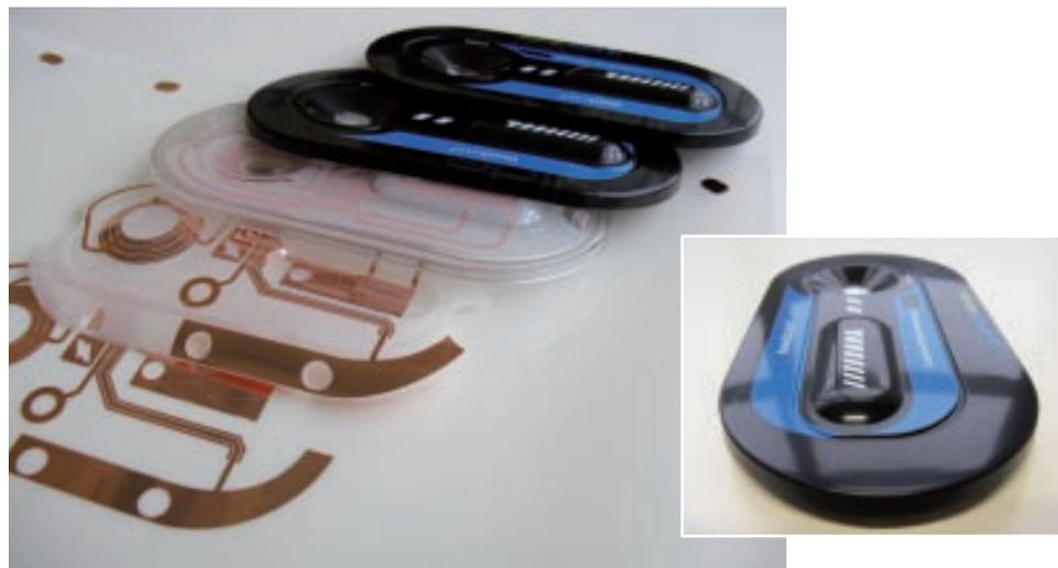
Von der Sensorfolie (ganz links) bis zum fertigen Sandwich-Bauteil aus Sensorfolie und schwarzer Dekorfolie (ganz rechts)
