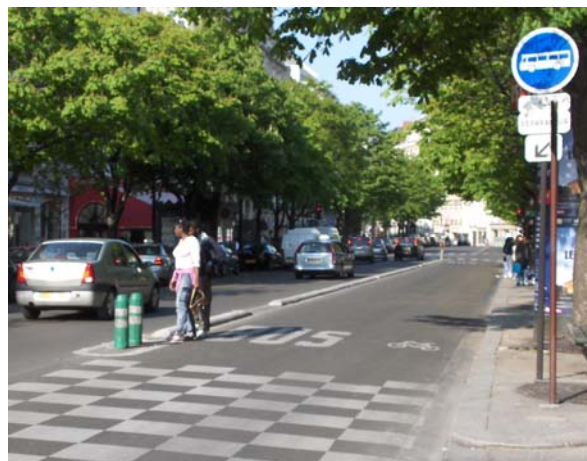
Kuva 11. Bussikaista on erotettu betonikokkeella muun liikenteen kaistoista Rue Saint-Lazarella Pariisissa.
