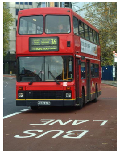
Kuva 12. Havaitsemisen tehostamiseksi on käytetty valkoista kaistamerkinä ”BUS LANE” ja kaista on maalattu punertavaksi eräällä Lontoon linja-autokaistalla (Britton 2005)
