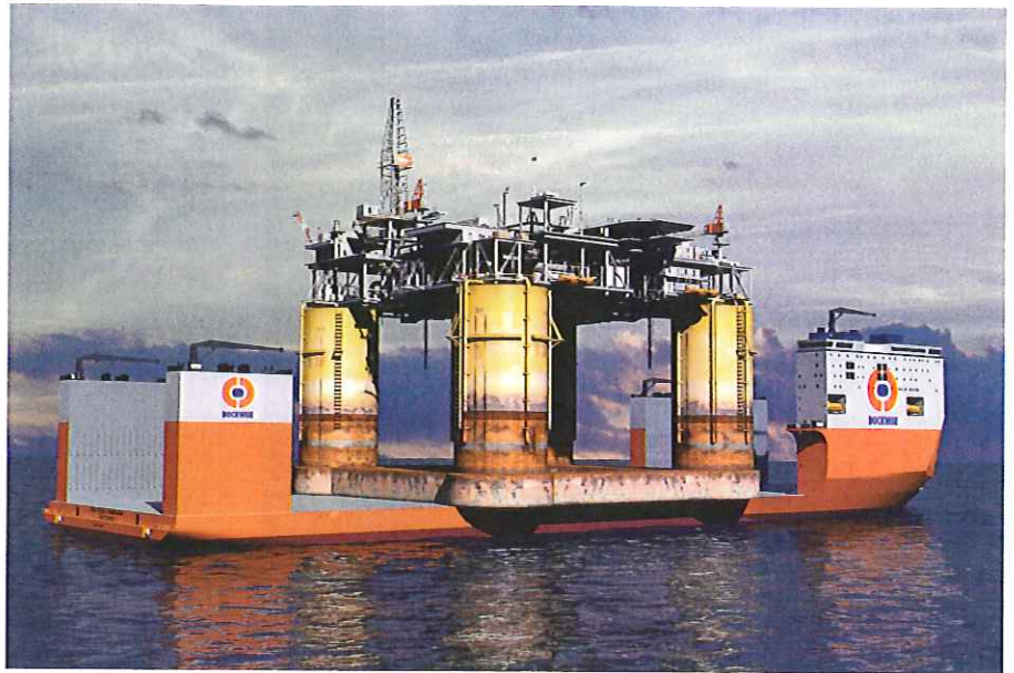
Komplette Bohrrinseln bis zum Gewicht von 110 000 t können an Deck der „Dockwise Vanguard“ geladen werden Abbildung: Dockwise
