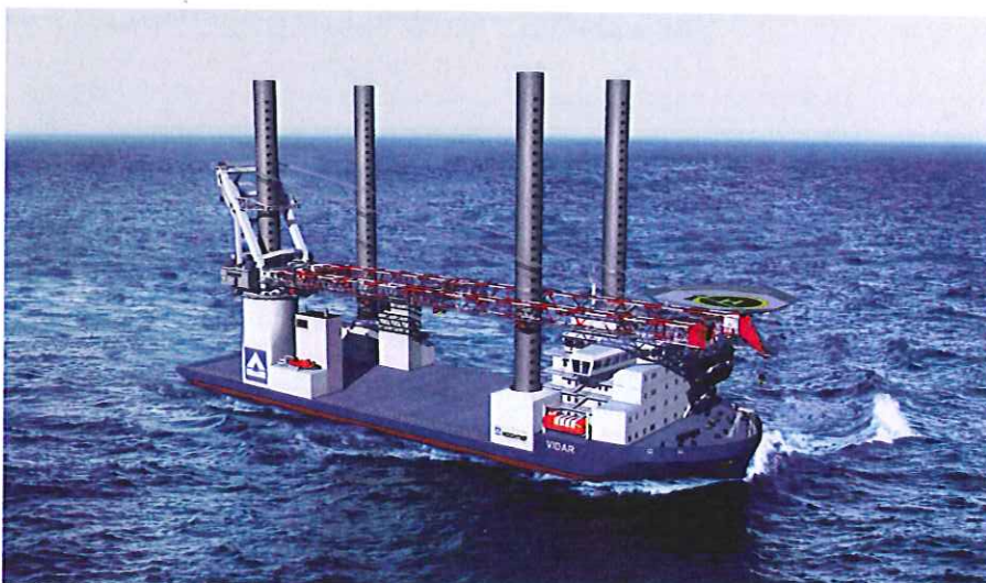
Das Installationsschiff „Vidar“ unterscheidet sich durch Kranaufstellung und Hubbeinkonstruktion von seinem Vorgänger
