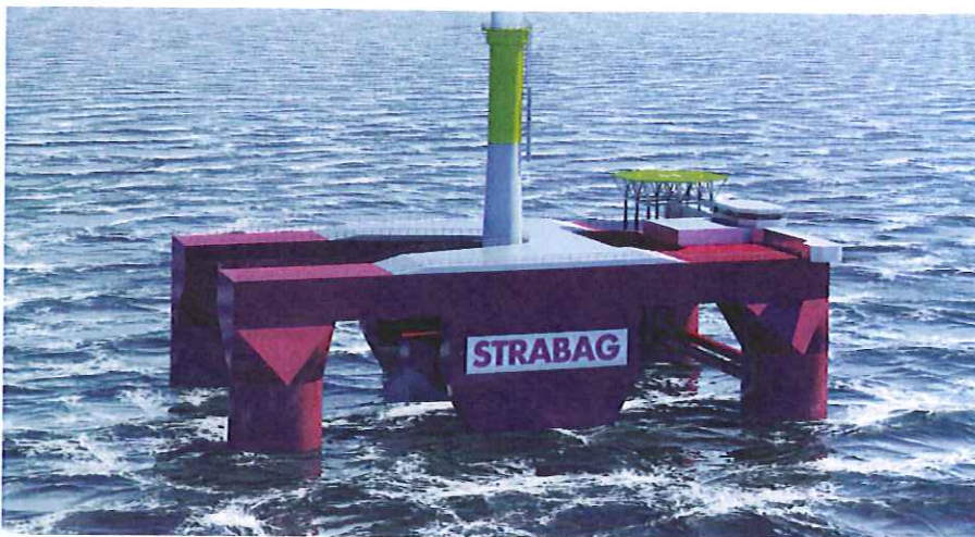
Der Strabag-Katamaran soll die kompletten Windkraftanlagen mitsamt Fundament transportieren und absetzen
