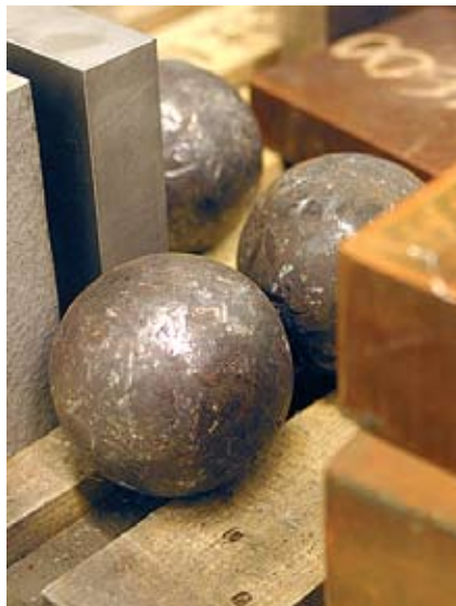
Ball-on-block näytteitä ja testikuulia. Laitteistolla tutkitaan raskasta, iskumaista kulumista.
