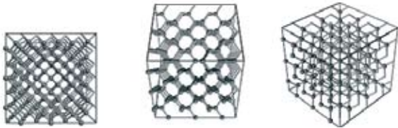
Yksikiteisen piin rakenne eri kidesuunnista katsottuna: <100>, <110>, <111>. / Single crystalline silicon lattice viewed from different directions: <100>, <110>, <111>.
