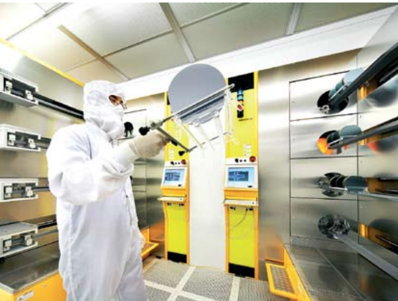
Micronovan puhdistilan oksidointi- ja diffuusiouunit. / Furnace section of Micronova cleanroom.
