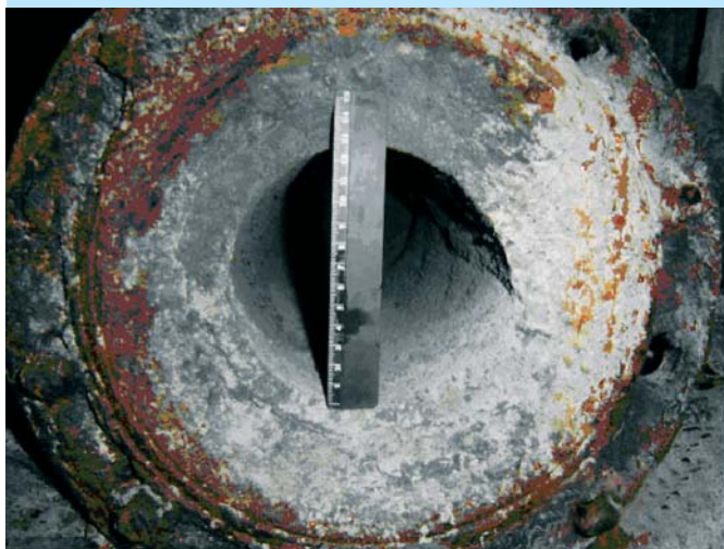
1. Степень зарастания трубопровода (48 мм на сторону) и состояние минеральных отложений (по твердости близко к бетону) без применения установок «Илиос». Остаточная пропускная способность менее 40 %
