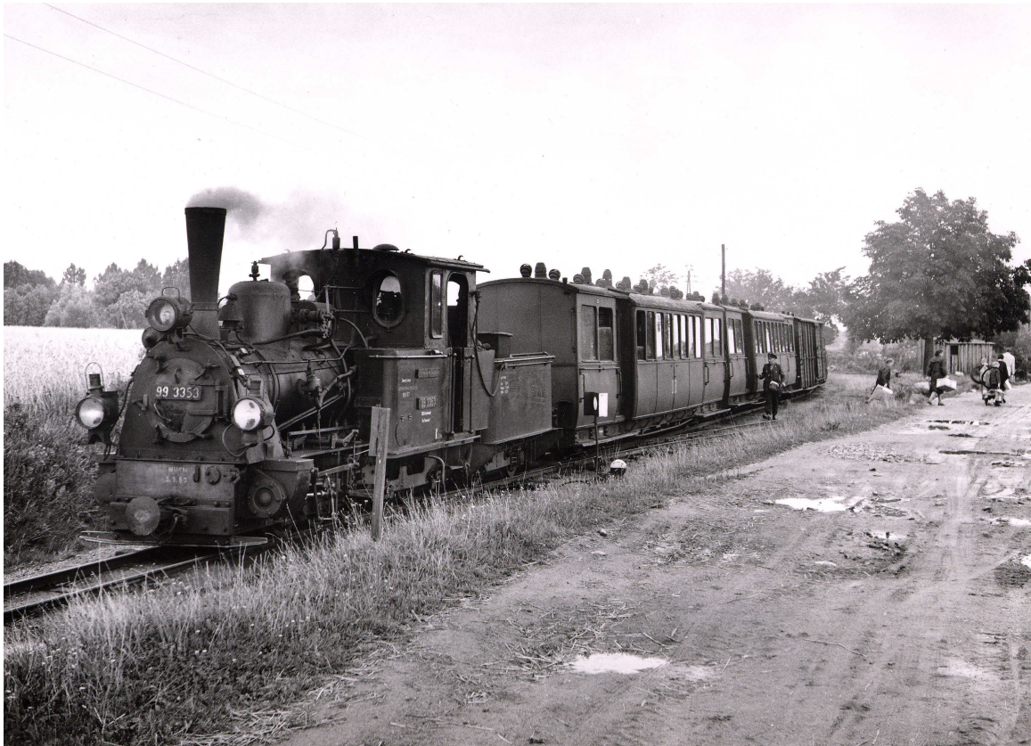
Lok 99 3353, C1'n2t Jung 1261/1908, in Nerdin mit Zug in Richtung Wegezin – Dennin – Friedland.
