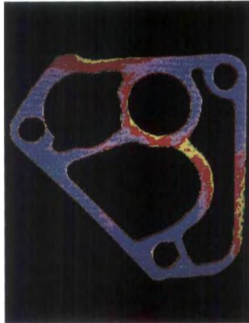
Untersuchungen der Beanspruchung dienen der Dauerhaltbarkeit: hier Pressungsverteilung an einem Ölfilterflansch, gemessen mit digitaler Bildverarbeitung.
