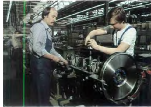
Montage schwerer Nutzfahrzeugmotoren in unserem Werk Berlin-Marienfelde: hier Einlegen der Kurbelwelle.
