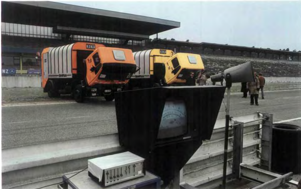
Geräuscharme Nutzfahrzeuge mit gekapseltem Triebwerk - Demonstration der bisher erzielten Ergebnisse eines Forschungsvorhabens im Motodrom Hockenheim im November 1981.
