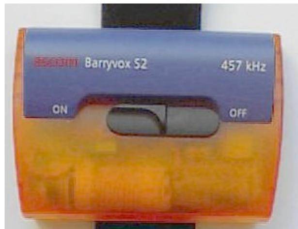
Le BARRYVOX S2 d'Ascom est un simple émetteur cadencé à 457 kHz qui a la même utilité que le LIFE BIP 3. Ces deux appareils augmentent les chances d'être secouru à temps lors d'une avalanche mais ne peuvent pas être utilisés comme récepteur pour rechercher les victimes ensevelies.
