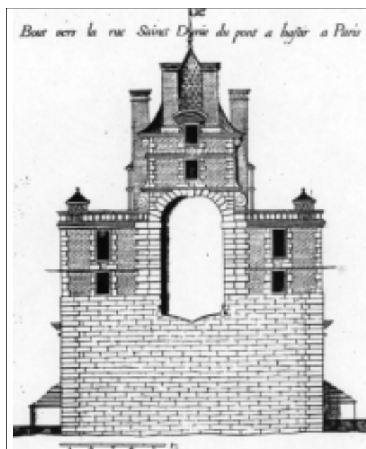
FIG. 5. PROJET DE MARCEL LE ROY POUR LE PONT AU CHANGE À PARIS. Elévation de l'entrée du pont sur la rive droite (gravure avec la légende): "Bout vers la rue Saint Denis du pont à bastir à Paris". B.n.F., Estampes, Va. 221 b. fol.
