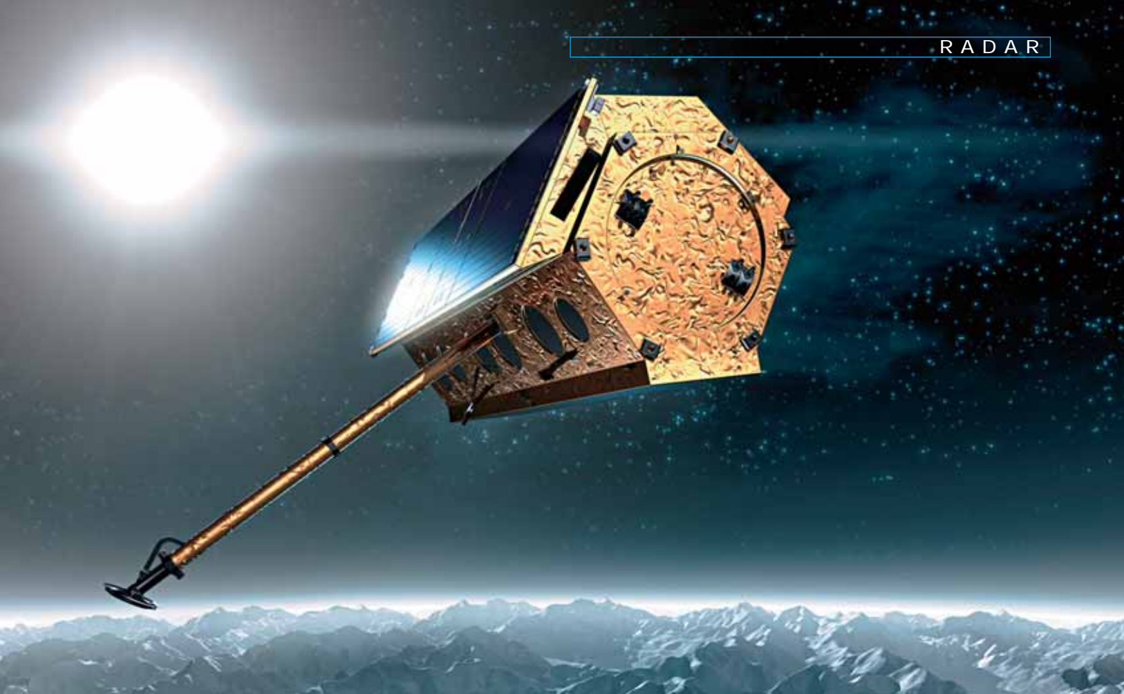
Das fliegende Auge: Die Energieseite ist der Sonne zugewandt, die nach unten gerichtete Fläche enthält die SAR-Antennen. Die Kommunikation zur Erde läuft über die abgespreizte Antenne.
