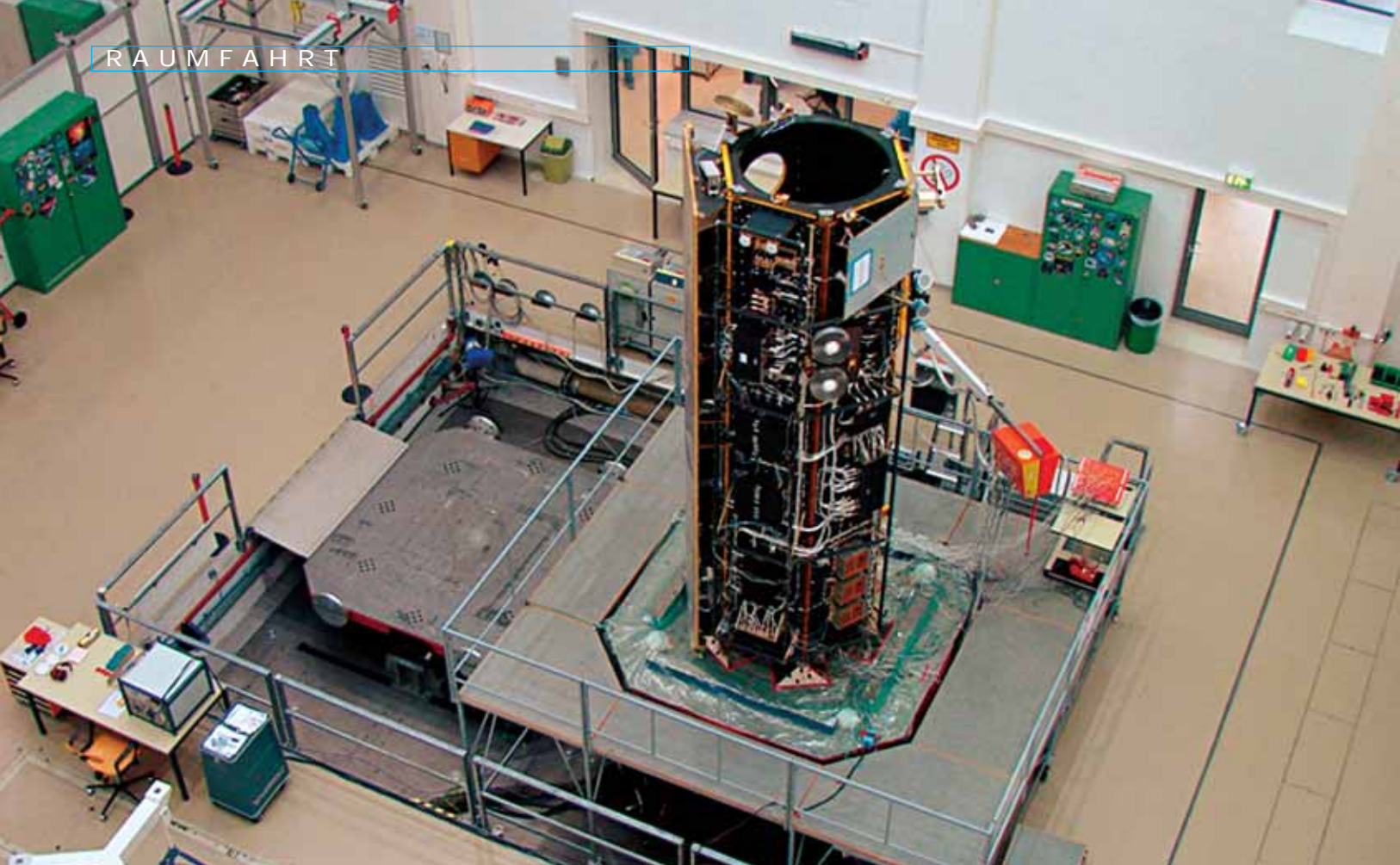
Zur Simulation der Weltraumbedingungen wird der TerraSAR-X zur Zeit bei der Firma IABG in Ottobrunn bei München umfangreichen Tests unterzogen. Die Satelliten-Komponenten werden überwiegend von EADS SPACE selbst entwickelt und hergestellt.
