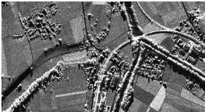
Detailansicht: Durch seine Zoom-Fähigkeit kann TerraSAR-X seine Auflösung in drei Stufen um das 16-Fache steigern. Ein Pixel im rechten Bild ist 16 Meter groß, links ein Meter.
