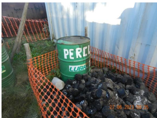
Ilustración 5: Depósito de restos de percloroetileno y de muestras sin un adecuado sistema de contención de derrames
