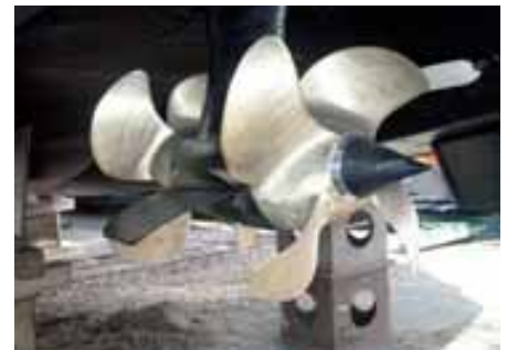
Die ‚Inselstadt Ratzeburg‘ ist das erste Schiff, in das der neue Schottel-Twinpropeller STP 110 eingebaut wurde Bild: Guddat
