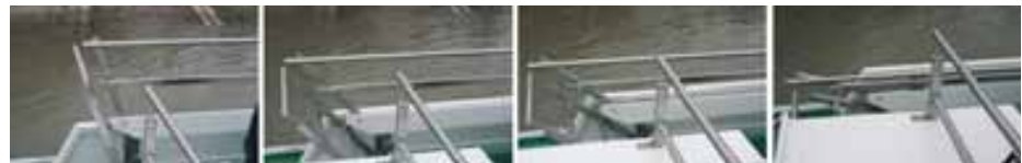
Weg damit: Bei zu niedrigen Brücken kann der Kapitän die Rehring einfach hydraulisch einklappen lassen Bilder: Mainzer
