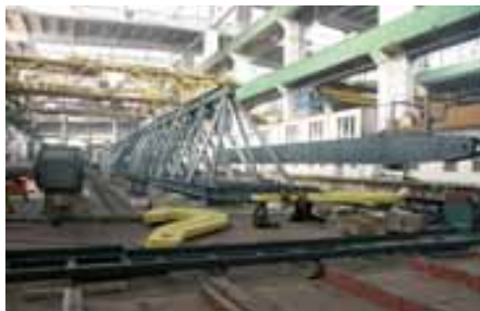
Endfertigung des Portalkrans für den Hafen Magdeburg Bild: Dünner
