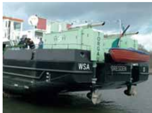
Am Heck sind gut die beiden Schottelantriebe mit darüber stehenden Motorenhäusern zu sehen
