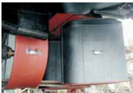
Blick auf die neue Propellerdüse Typ HODI Superior mit Düsenpropeller von van Voorden und die neue Hitzler – Doppelrudernanlage
