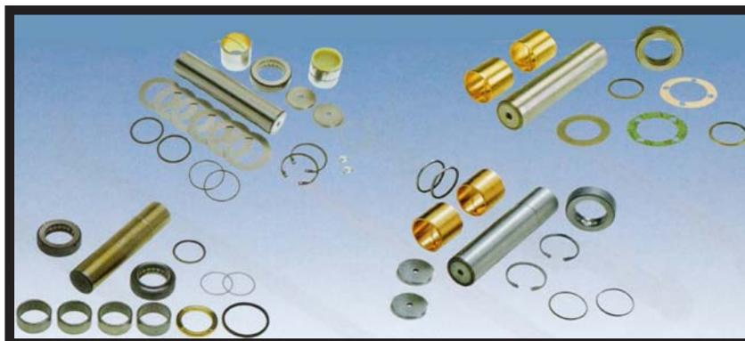
**Il kit di perni fusi a snodo contengono tutti i ricambi necessari per la riparazione del veicolo. Nell'ordine indicare sempre il numero di assali e il numero di telaio**
