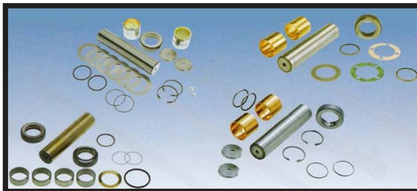
I kit di perni fusi snodo contengono tutti i ricambi necessari per la riparazione del veicolo. Nell'ordine indicare sempre il numero di assali e il numero di telaio.
