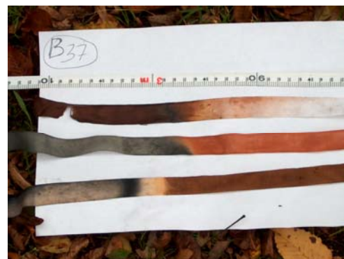
Bild 6: „In-Situ“-Redox-Milieu-Detektor nach Ablauf der Reaktionszeit
