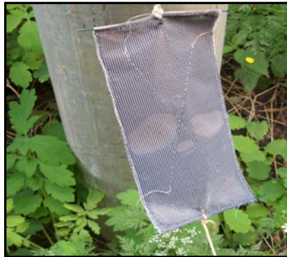
Bild 2: Passivsammler nach dem Ausbau (Netztafche mit innen liegendem Adsorbiermaterial)
